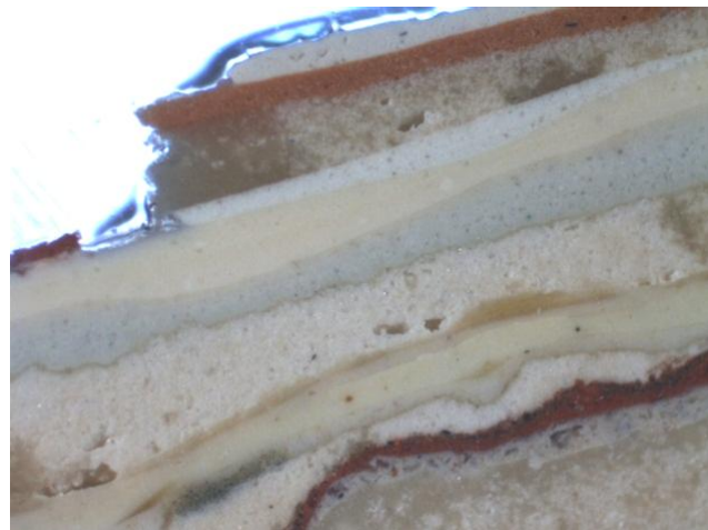
Poikkileikkausnäytteessä 1 näkyvät kerrokset 02–9 (alhaalta ylös).
