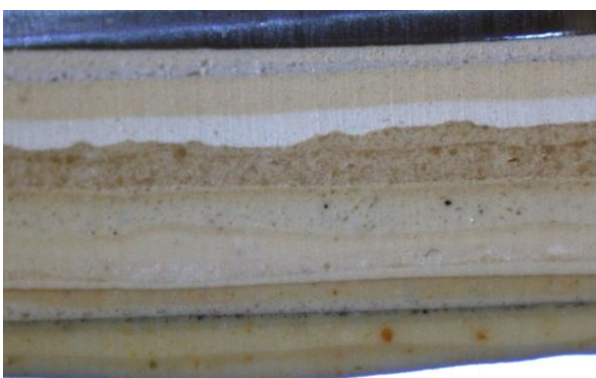
Poikkileikkausnäytteessä erottuvat kaikki kerrokset 01–7 (alhaalta ylös).
