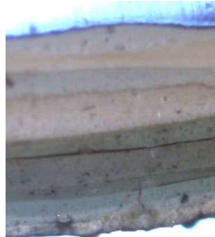
Kuva 91. Poikkileikkausnäytteessä 2 vihreiden sävyjen alla oleva kerros ei ole valkoinen, vaan sinivihreä. (Myyrä 2012)
