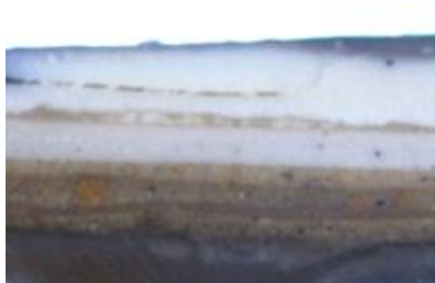
Poikkileikkausnäytteessä 1 erottuvat kerrokset 001–2 tummina kuvan alalaidassa.
