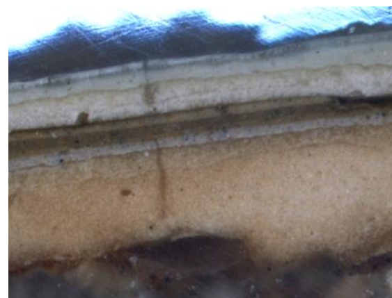
Poikkileikkausnäytteestä 2 voidaan erottaa kerrokset 01–3 (alhaalta ylös).
