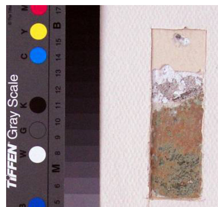
Kuva 45. Luokassa 112 seinän vanhin väritys on samankaltainen kuin aulassa. Okra kerros vihreän päällä on punertavampi kuin aulassa. (Myyrä 2011)
