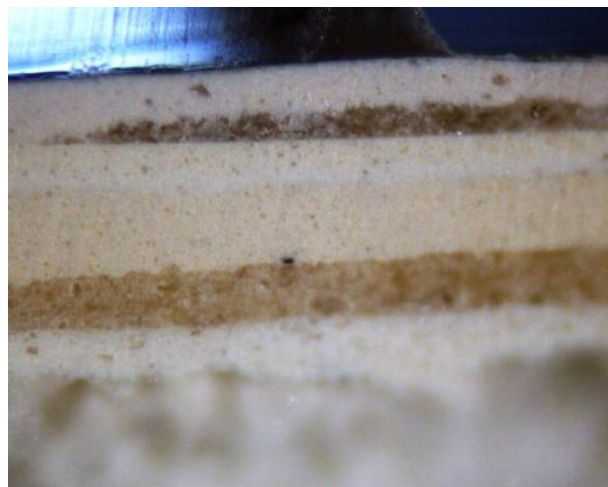
Poikkileikkausnäytteessä 2 näkyvät kerrokset 6–9 (alhaalta ylös).
