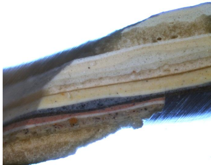
Poikkileikkausnäyte alaseinästä. Kuvassa kerrokset 01–7.
