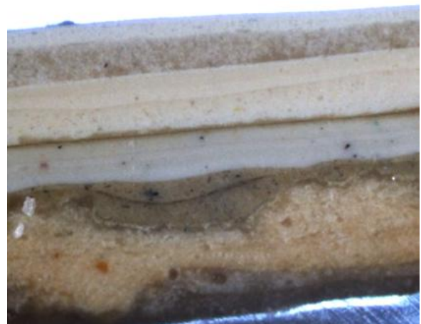
Poikkileikkausnäyte 1 yläseinästä. Kuvassa erottuvat kerrokset 1 ja 03-7 (alhaalta ylös).
