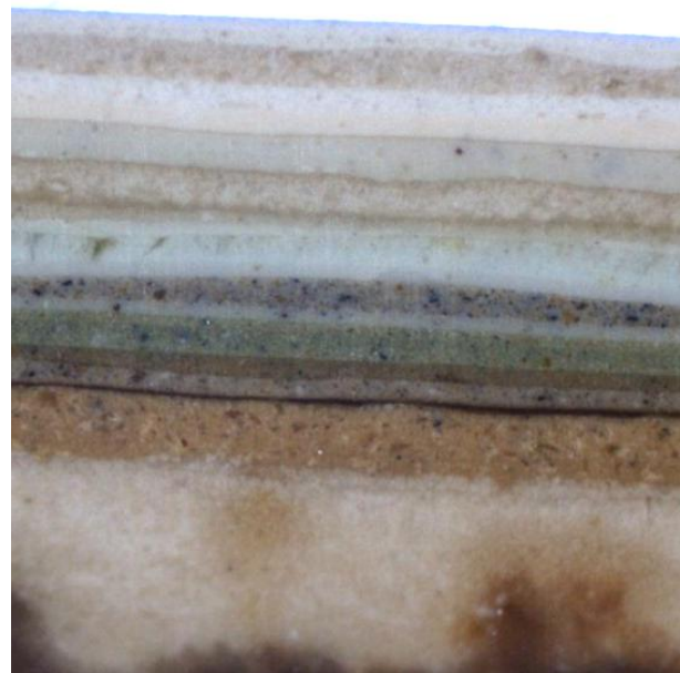
Poikkileikkausnäyte alaseinästä. Kuvassa kerrokset 001–7.
