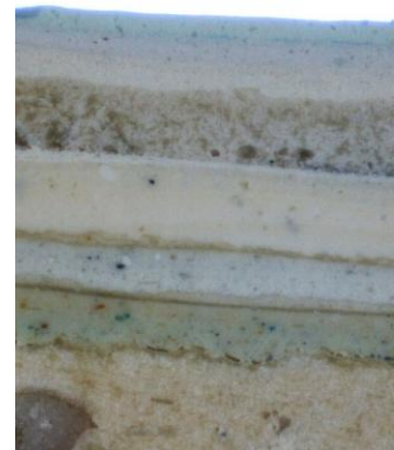
Poikkileikkausnäytteessä 1 kerrokset 1–7 järjestyksessä ylhäältä alas.
