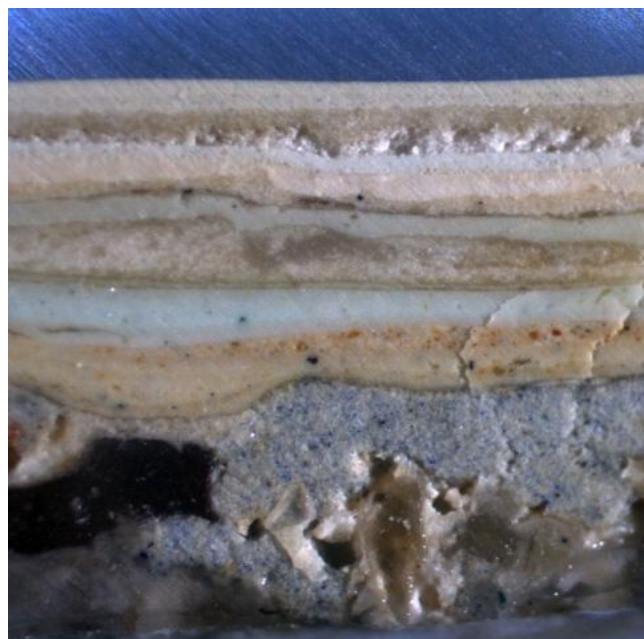
Poikkileikkausnäyte yläseinästä. Kuvassa näkyvät kerrokset 0 ja 3-7.
