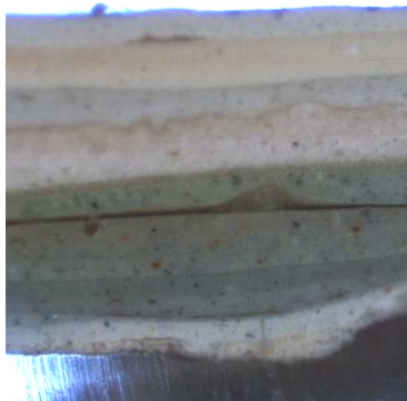
Kuva 90. Poikkileikkausnäytteessä 1 vihreiden sävyjen alla on valkoinen, mikä tulkittiin pohjamaaliksi. (Myyrä 2012)
