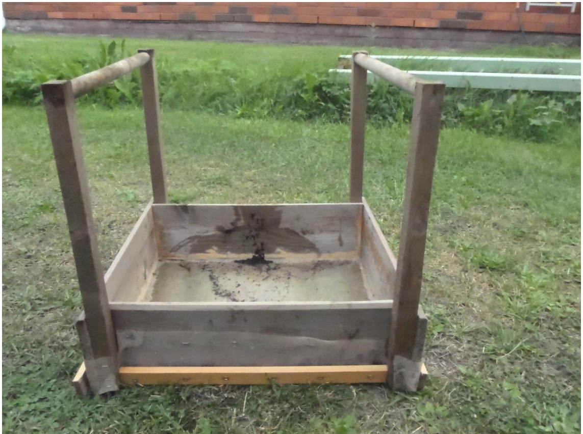
Kuva 4: Näytteenottoa varten rakennettu siivilä.
