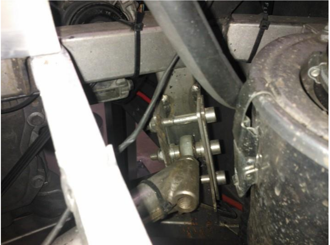
Kuva 6. Ylätukivarteen alkuperäisessä konstruktiossa hitsattu holkki, johon nivel oli kiinnitetty.
