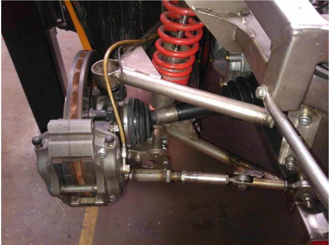
Kuva 5. Ylätukivarsi kiinnitettyä olka-akseliin Volkswagen Kuplan pallonivelellä.
