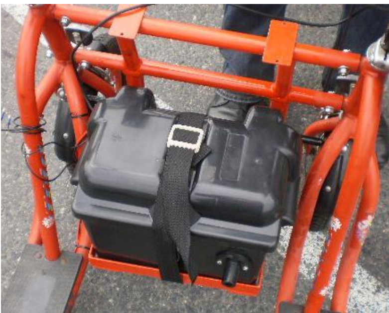
KUVA 5. Akkuteline asennettuna (Valokuva Asko Liukkonen 2011)
