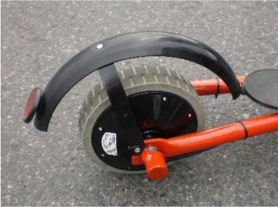
KUVA 9. Lokasuoja ja akselinpäiden suojat asennettuina (Valokuva Asko Liukkonen 2011)
