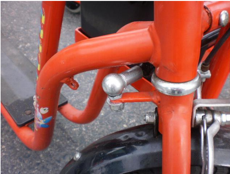
KUVA 7. Raidetanko asennettuna (Valokuva Asko Liukkonen 2011)
