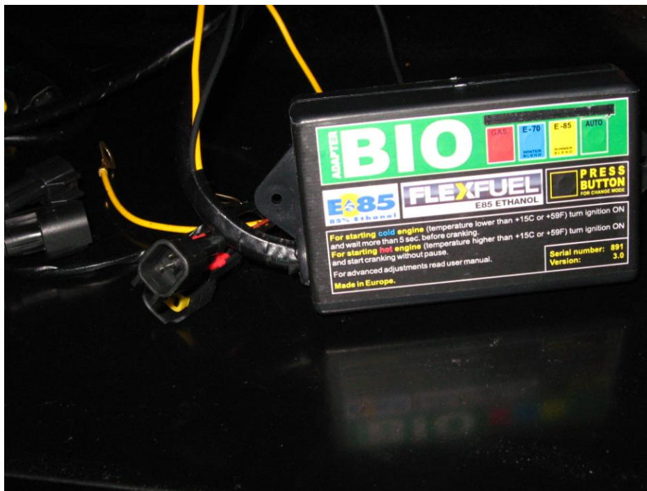
KUVA 4. Muutossarja, jolla tavallisesta bensa-autosta saadaan muutettua FFV-ajoneuvo (Kuva: Tiina Eskola 2012)
