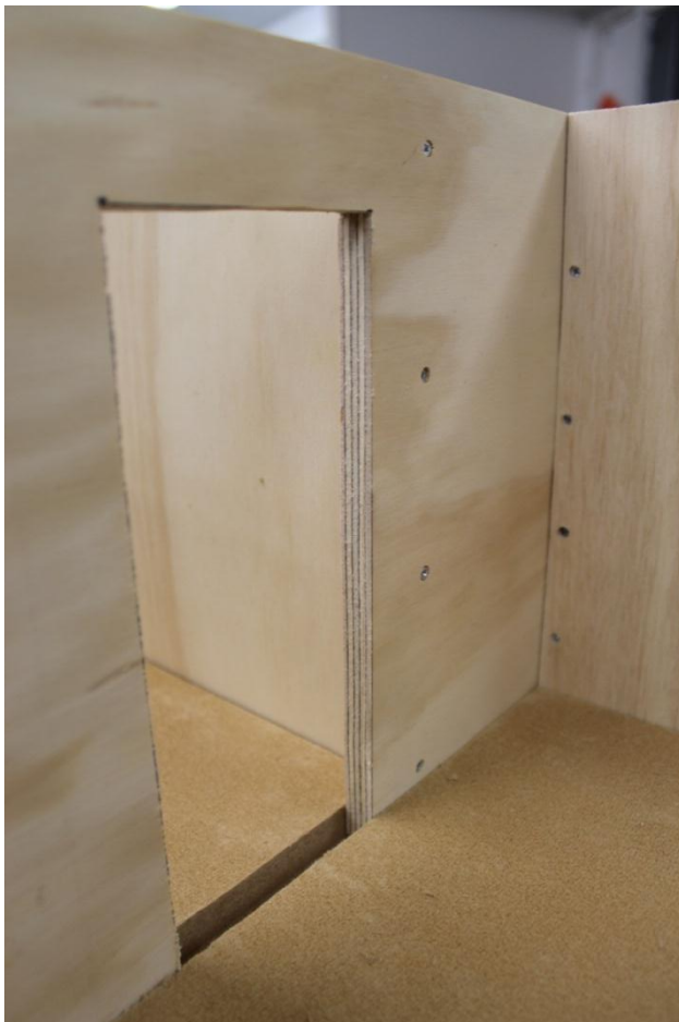
Kuva 13. Pienoismallitalon väliseinien ruuviliitoksesta
