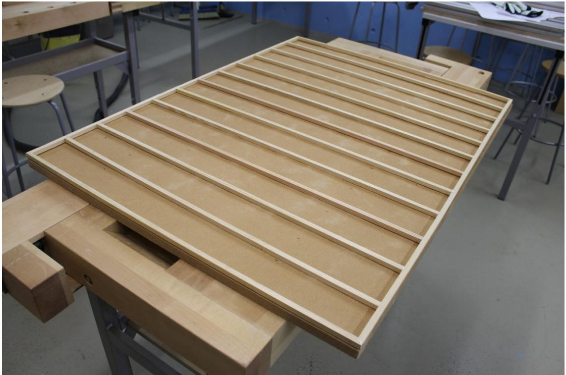
Kuva 14. Pienoismallitalon yläpohjarakenne ilman viimeistä puukuitulevyä.
