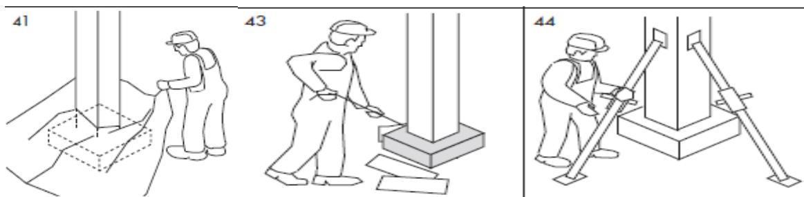
Figur 26. Vanliga efterarbeten vid pelarmontering, med andra ord övertäckning, rivning av formor och borttagning av strävor. 3
