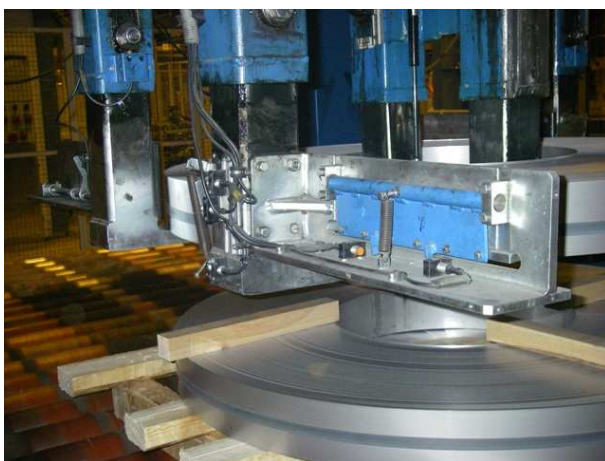
Kuva 16. Lavausrobotin tarttujat lähikuvassa
