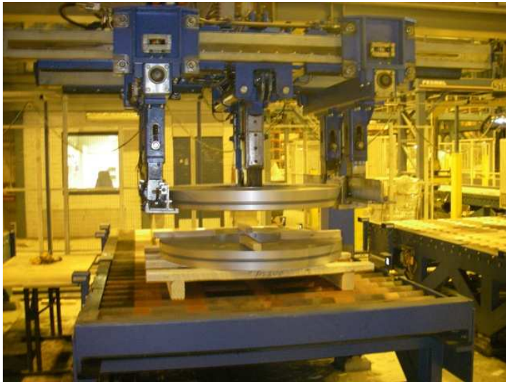
Kuva 14. Lavausrobotti Veijo laskemassa kaistoja lavalle
