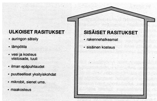
Kuva 3. Rakennuksen sisäiset ja ulkoiset rasitustekijät.
