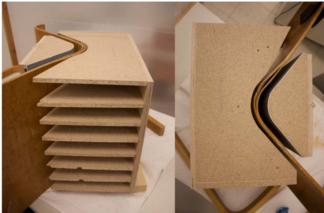
Kuvat 13–14. Puristusmuotin koverasta osasta puuttuu kuvassa vielä tuolin pintaa vasten tuleva ohut vaneri, joka kuperassa muotissa on jo paikalleen taivutettu ja kiinnitetty.
