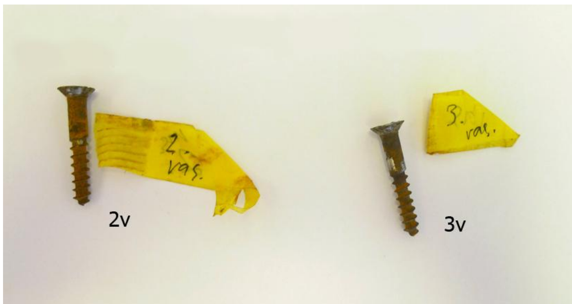
Vasemman jalan ruuvit 2 ja 3 ennen ruosteen poistoa
