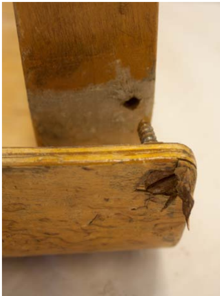
Kuva 17. Piiloruuvi menee jalkaan istuimen etukulmasta ja sitä peittää pintaviilu.
