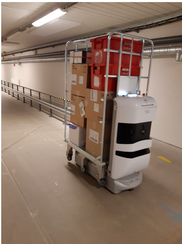
Kuva 8. Kuljetusautomaatti on suorittamassa varastokuljetusta.
