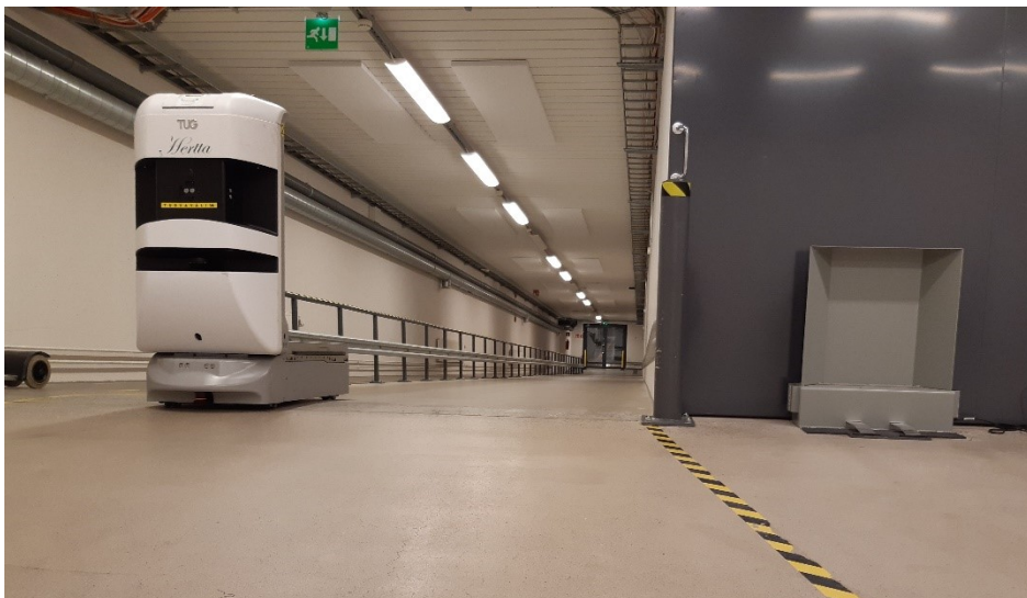
Kuva 4. Kuljetusautomaatti TUG T3 saapuu luiskaa pitkin keskusvarastolle. Kuvassa oikealla on kuljetusautomaatin telakka.
