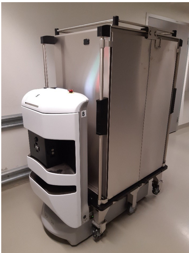
Kuva 7. Kuljetusautomaatti on suorittamassa välinehuollon kiertoa.
