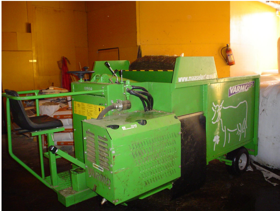
KUVIO 6. Dieselmoottorilla ja leikkuriterällä varustettu rehunjakovaunu (Manninen 2006)
