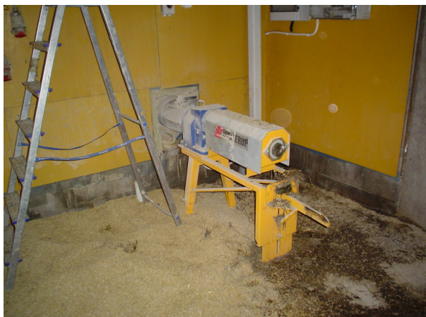
KUVIO 15. Seosrehurobotin sähkömoottori (Manninen 2006)
