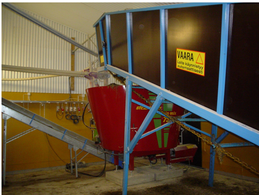
KUVIO 14. Täyttöpöydällä täytettävä kiinteä apesekeitin, josta seos jaetaan eläimille matoruokkijalla (Manninen 2006)
