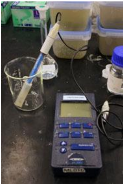
Kuva 6. WTW pH 330i – SET – pH- mittarilla
