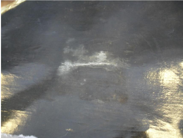
Kuva 26. Lakkapinnan rapautuminen paikallisen suoristuksen jälkeen
