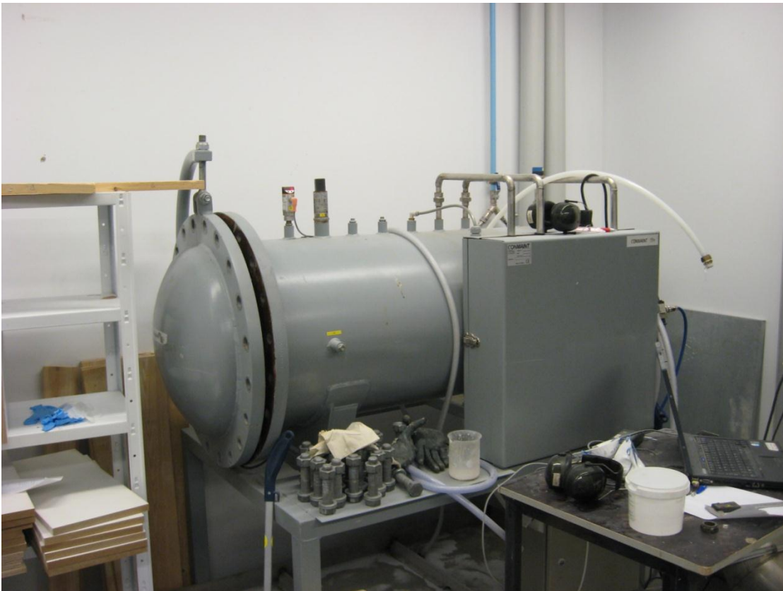
Kuva 1. Paineekyllästys sylinteri. Savonia-ammattikorkeakoulun puutekniikan laboratorion painekyllästys sylinteri. Kuva Aku Lindgrén 2012.
