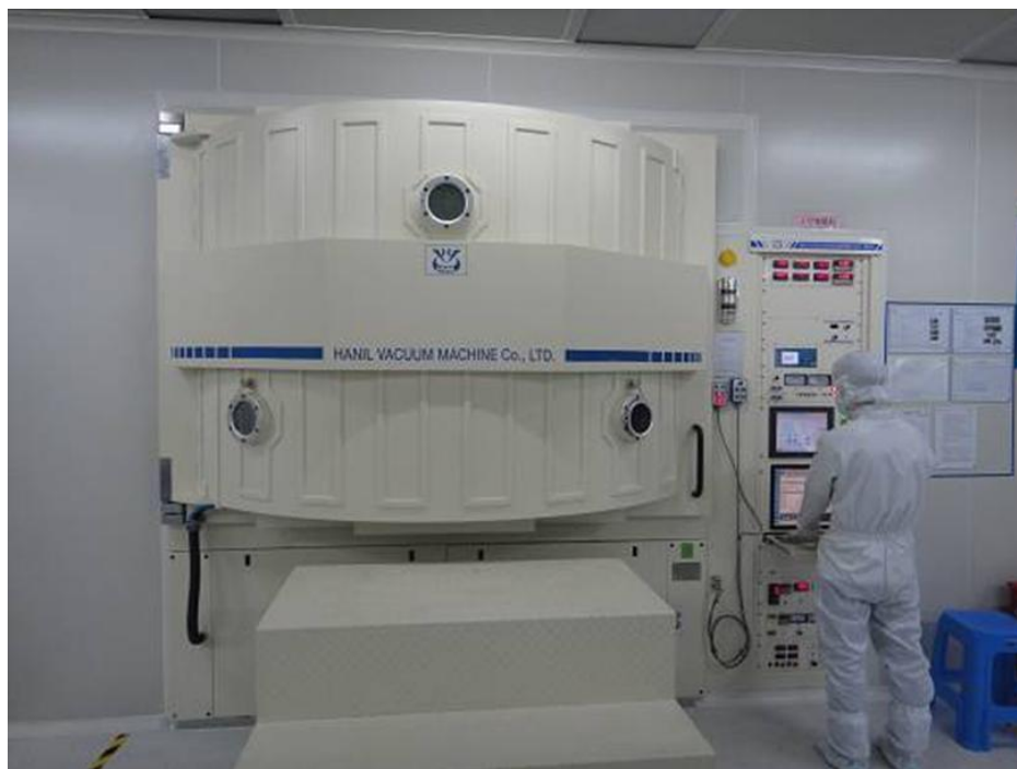
KUVA 7. Electron Beam Vapor Deposition -laitteisto (1)
