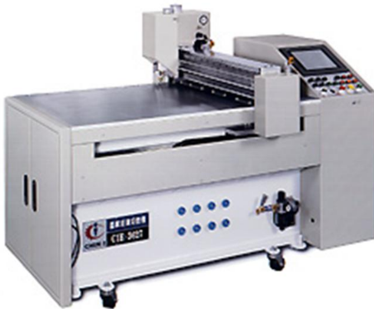
KUVA 2. Lasin leikkaukseen käytetty automaattinen leikkauskone (1)
