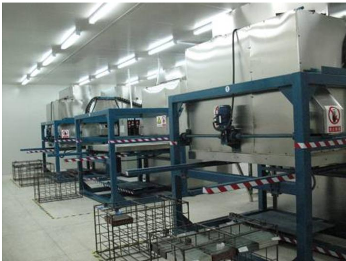
KUVA 5. Kemiallisessa karkaisussa käytettäviä uuneja (1)
