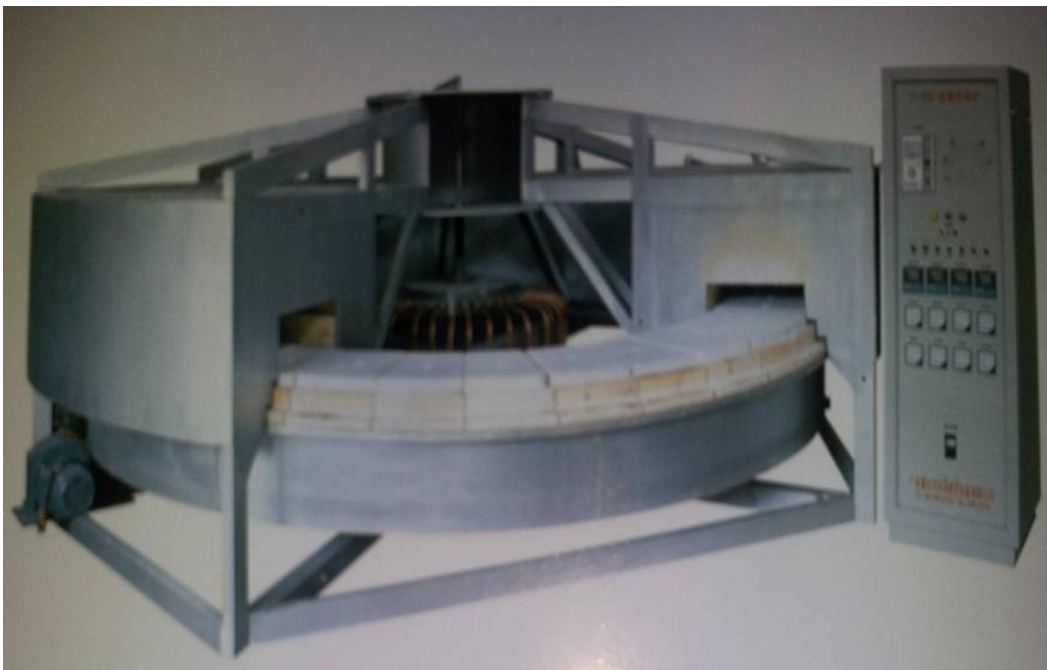
KUVA 12. Karuselli tyyppinen kuumataivutusuuni (1)
