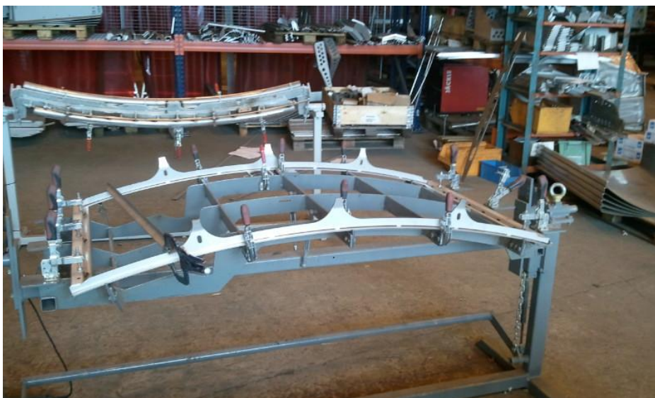
Kuva 8. Oven hitsauskokoontaminen tapahtuu hitsauspukkien päällä.
