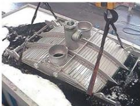
Kuva 10. Isot ja monimutkaiset kappaleet on helpompi peitata altaassa./17/
