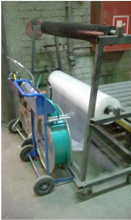
Kuva 15. Pakkauksessa käytetään kuplamuovia ja se sidotaan muovivanteella kiinni.
