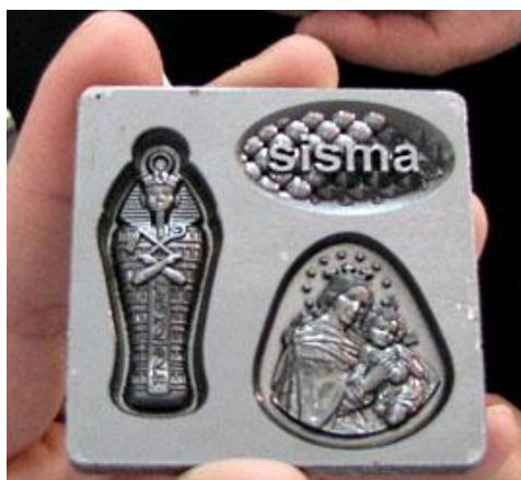
Kuva 3. Teräkseen mikrotyöstettyjä muotoja. /15/
