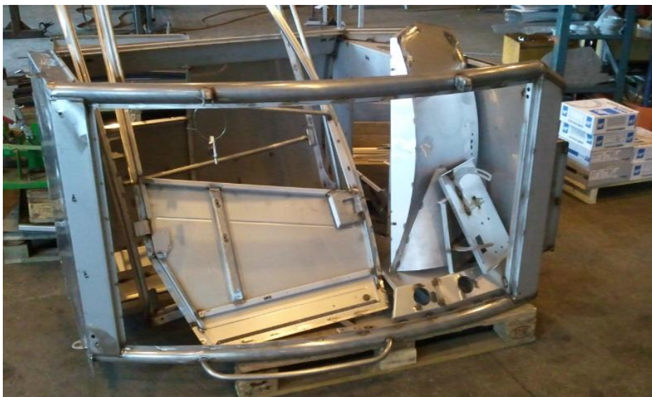
Kuva 12. Puutavarakuormaimen hytin osat odottavat peittaukseen menoa.
