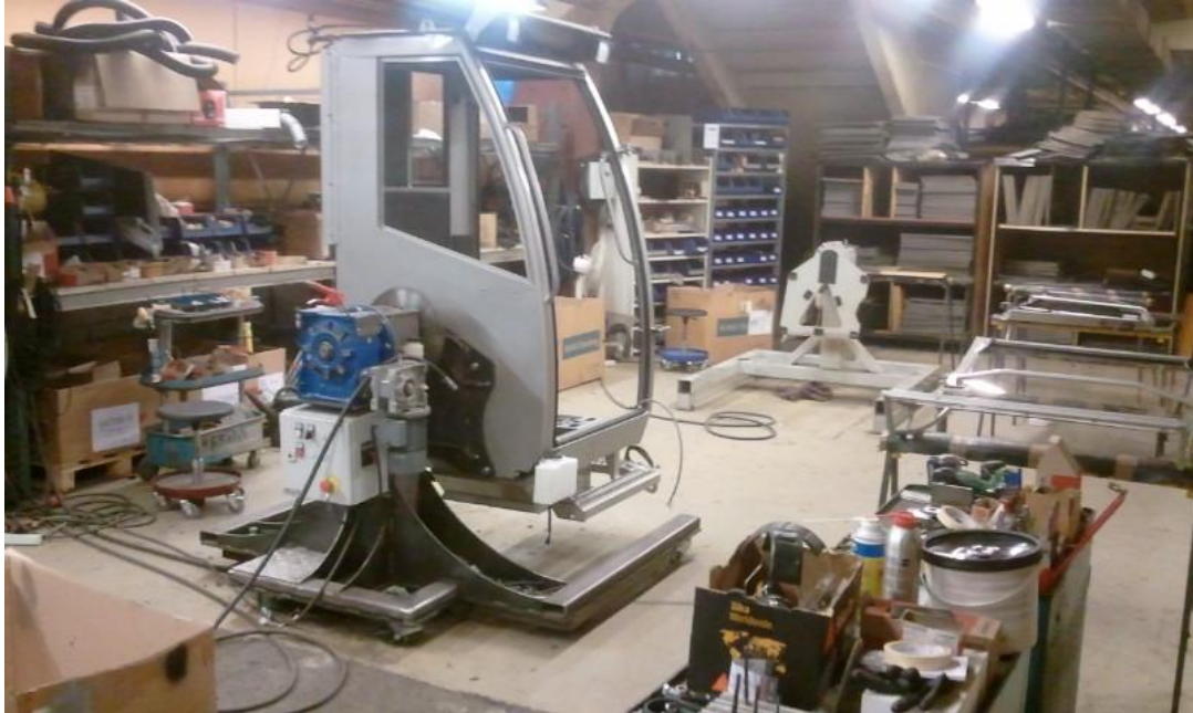
Kuva 14. Puutavarakuormaimen hytti kääntökehässä kokoonpanovaiheessa.
