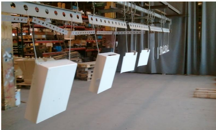
Kuva 13. Osat ovat juuri tuleet maalauksesta ja ne ovat kuivumassa.
