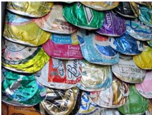
KUVA 42 Litistettyjä alumiinitölkkejä rakennusmateriaalina. (Recyclingrag 2004.)
