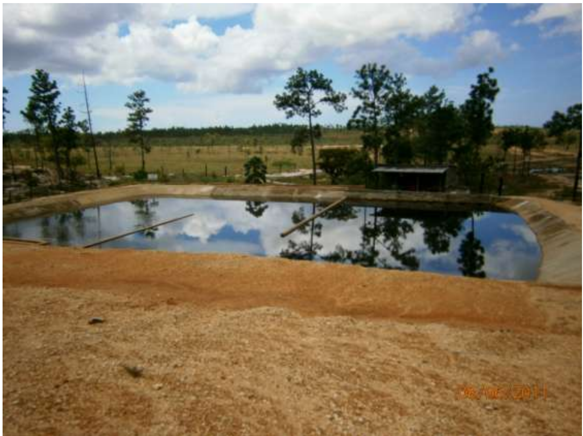
KUVA 7 Allas lannoitteen valmistusprosessissa, mihin orgaanista materiaalia johdetaan putkia pitkin. (Pietilä 2011)
