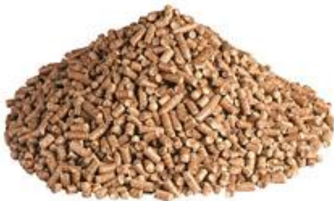
Kuva 5. Mekaanisen puutuotannon sivutuotteista polttovalmiiksi puristettuja pellettisylintereitä. (HLR-energia)
