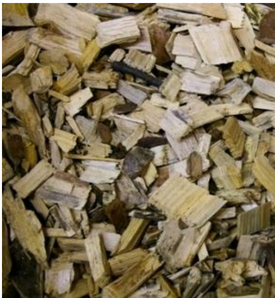
Kuva 4. Energiapuusta polttovalmiiksi hakettua hakelastua. (HT Enerco)
