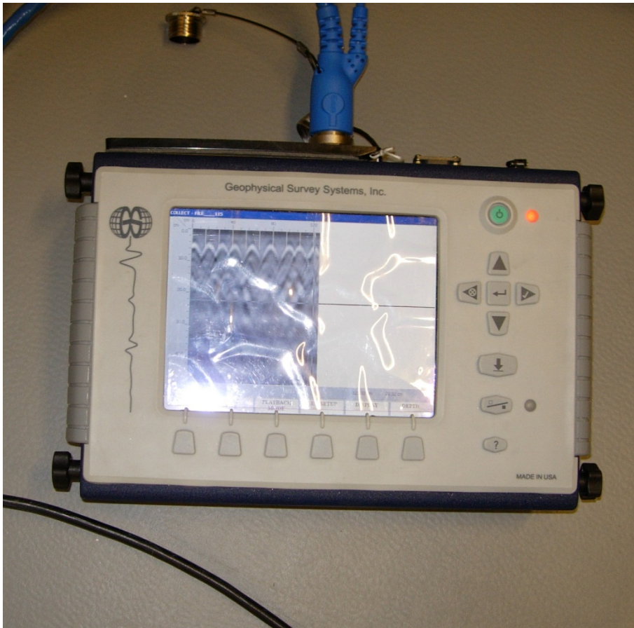
KUVA 24. Raudoiteverkon pystyterästen heijasteet
