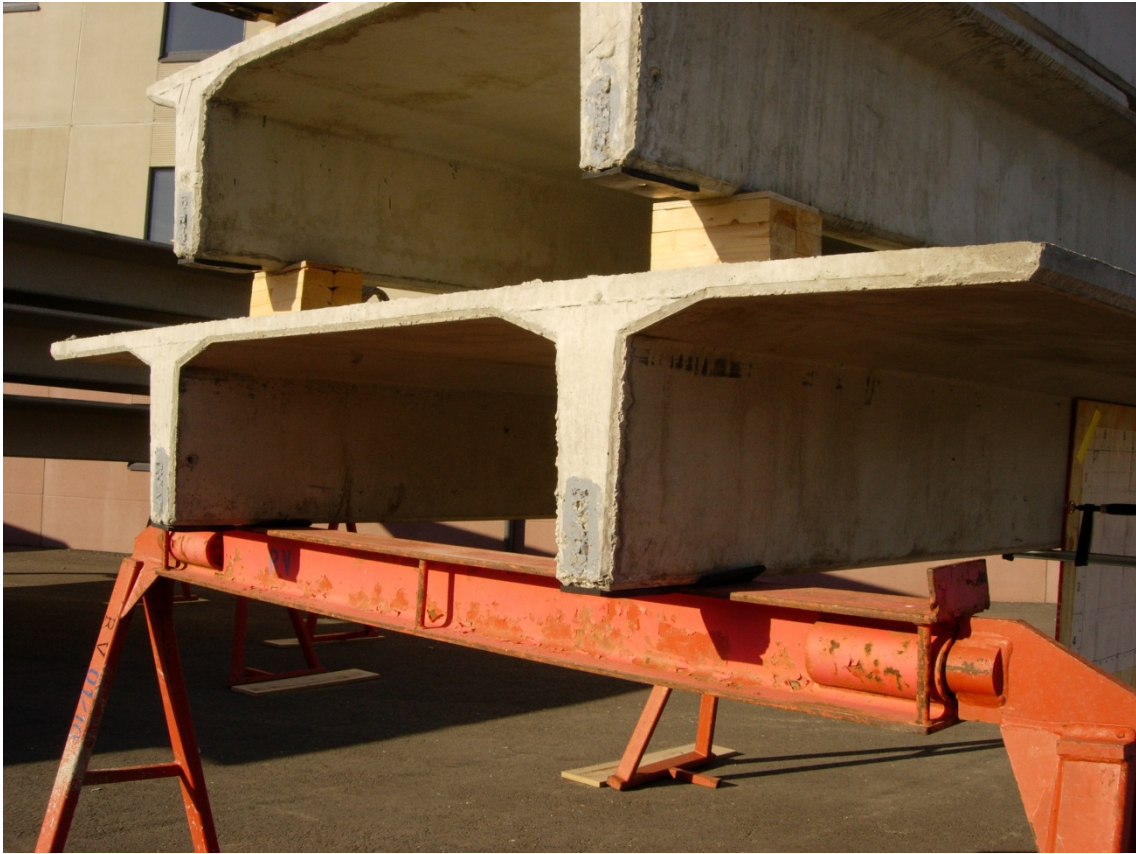
KUVA 19. TT-laatta tehtaan pihalla
