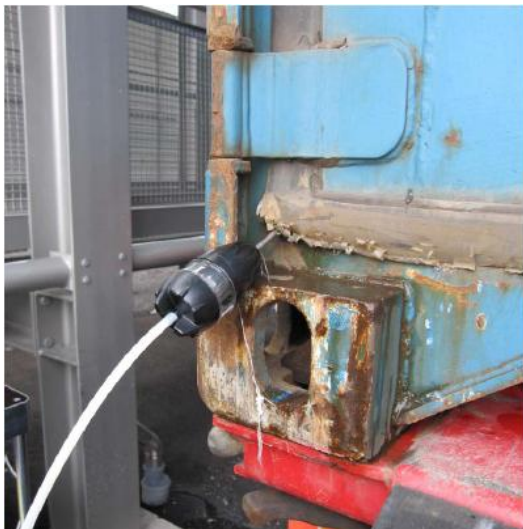
Figur 5. Provtagning med hjälp av en FTIR tub-sond(Kanerva, H., 2010,bilaga 2).
