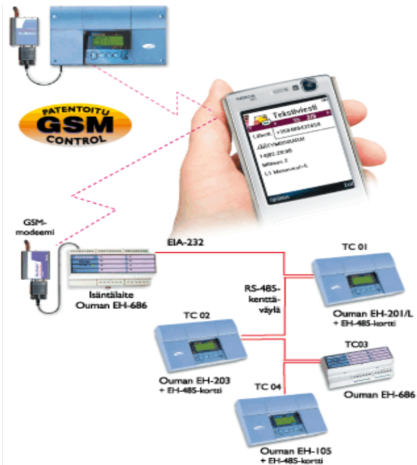
KUVA 5. GSM Control matkapuhelimella suoritettavaan etäkäyttöön (Ouman)
