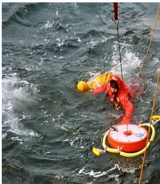
Figur 7-8. Räddningsnätet ligger dolt under ytan. När den nödstälde fått tag om livbojen hissas nätet upp och den nödstälde hamnar i "håven" (Schwindt)
