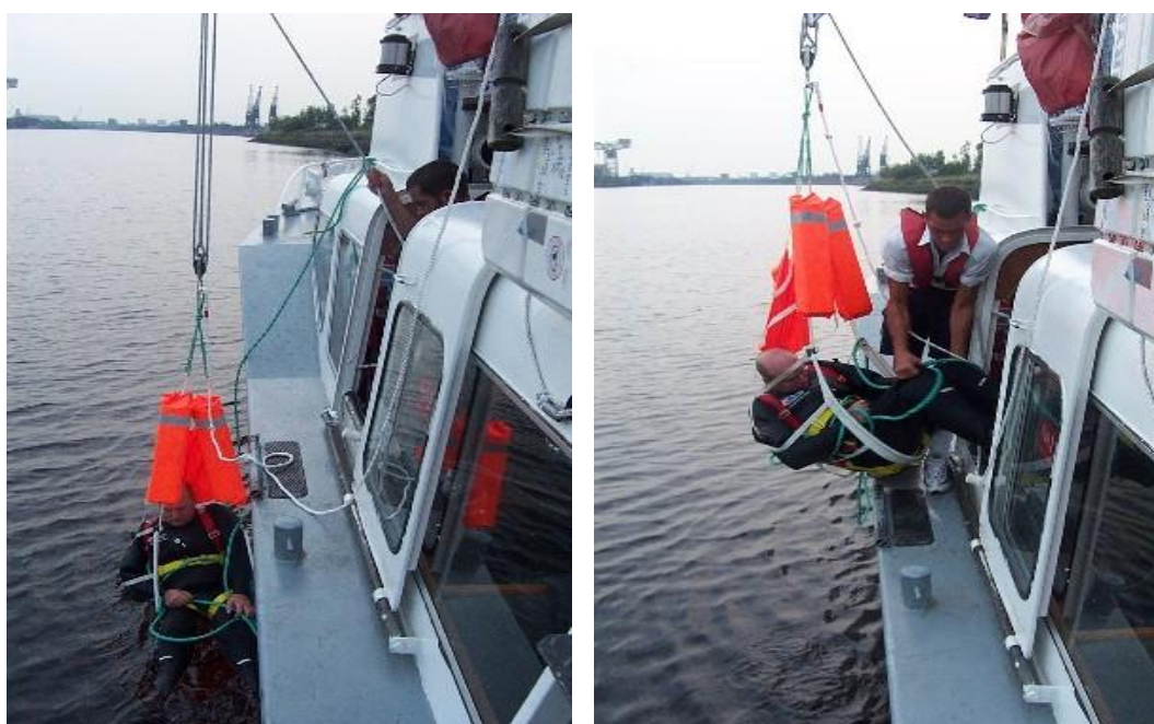
Figur 17-18. Personen lyfts ombord med hjälp av en bom med talja (Markus Lifenet Ltd)
