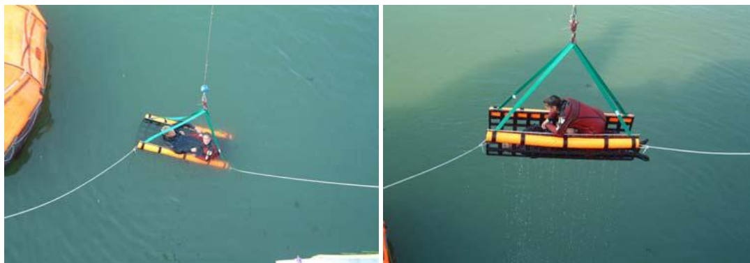
Figur 4-5. Den nödställda placeras på räddningsredskapet och lyfts ombord (Land & Marine Products Ltd)
