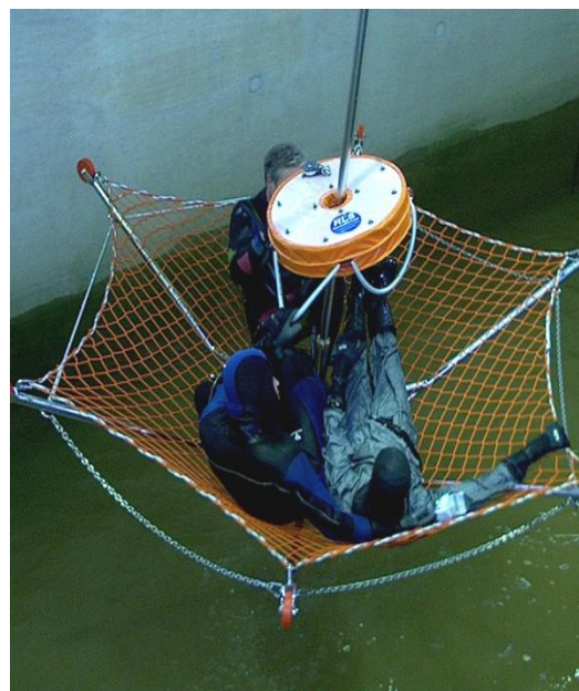
Figur 7-8. Räddningsnätet ligger dolt under ytan. När den nödstälde fått tag om livbojen hissas nätet upp och den nödstälde hamnar i "håven" (Schwindt)
