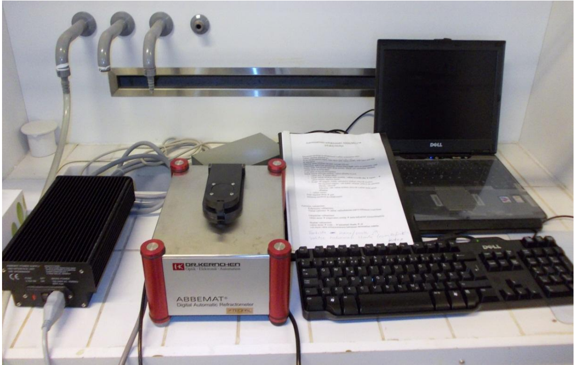
Kuvio 5. Taitekertoimen mittausyksikkö, joka on kytketty tietokoneeseen, johon on asennettu taitekertoimen mittausohjelma.
