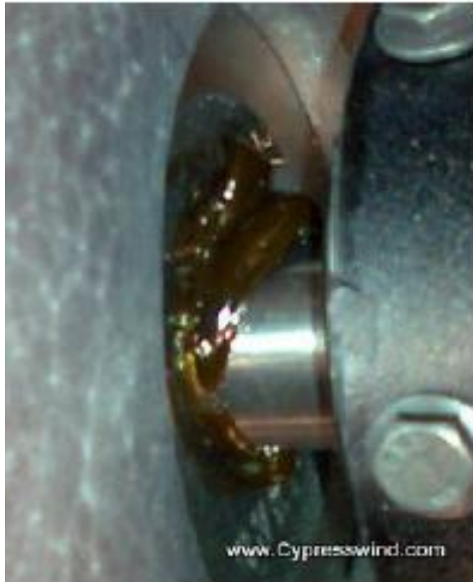
Kuva 4 Laakereiden rasvaus (Cypress Wind Turbines Oy manufacturing guide)
