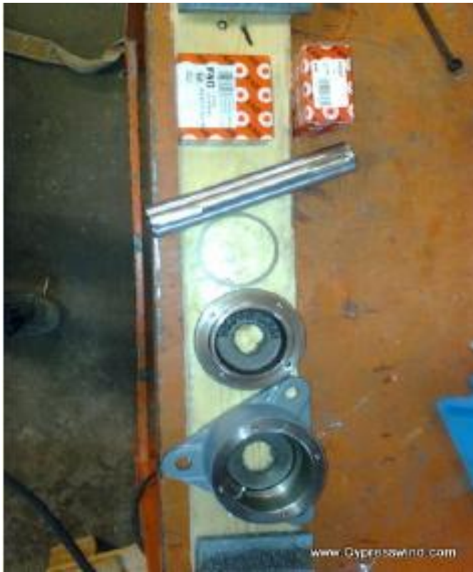
Kuva 6 Laakerin kannen avaus (Cypress Wind Turbines Oy manufacturing guide)
