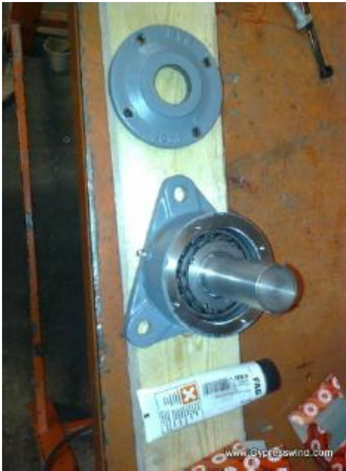
Kuva 8 Laakerin kannen kiinnitys (Cypress Wind Turbines Oy manufacturing guide)
