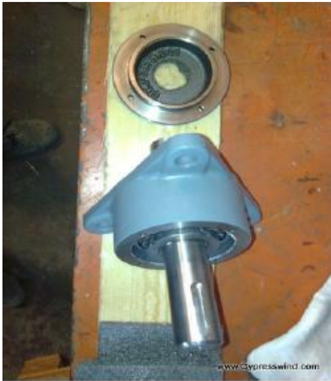
Kuva 7 laakerin ja akselin asennus laakeripesään (Cypress Wind Turbines Oy manufacturing guide)
