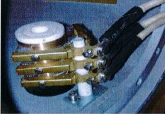
Kuva 22 Kaapeleiden kiinnityksen (WindSpot 3,5 kW user manual)
