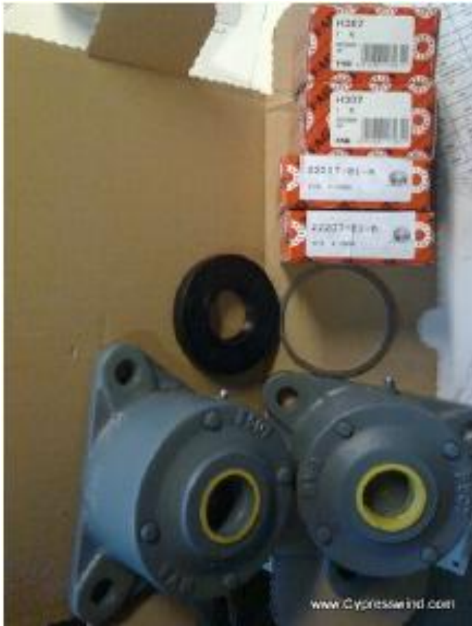
Kuva 5 Turbiinin laakerisarja sisältäen ala- ja yläpään laakerit (Cypress Wind Turbines Oy manufacturing guide)
