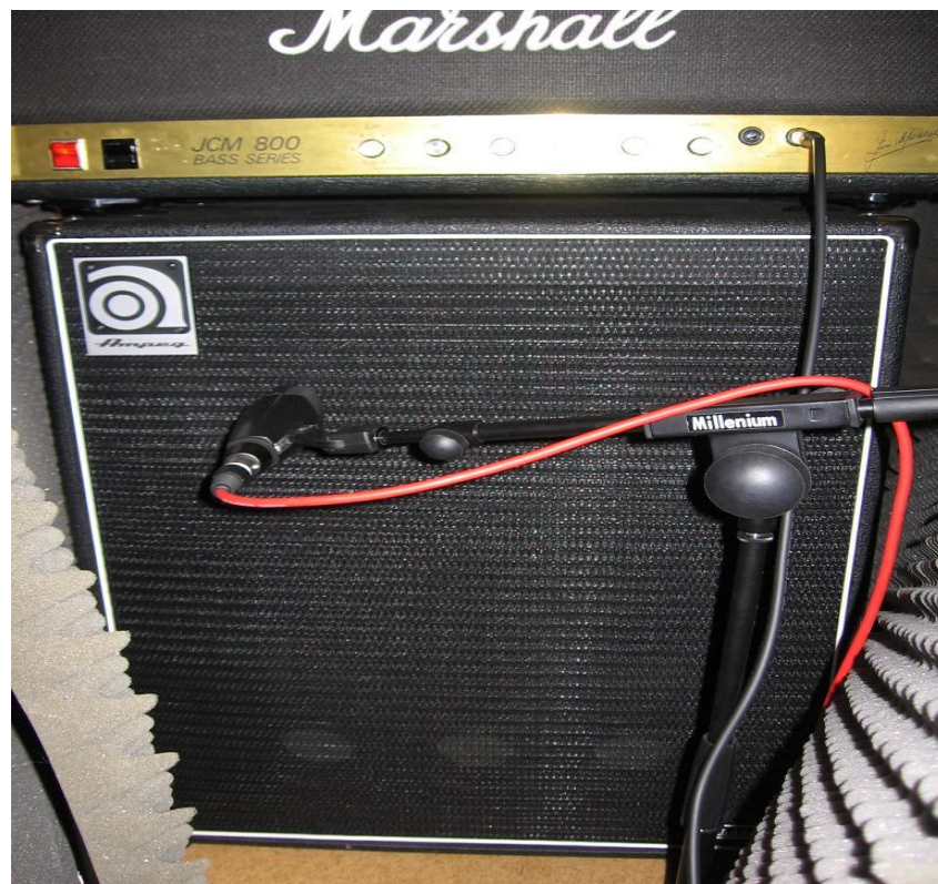
KUVA 10: Bassovahvistimen mikitys Sennheiser MD421:llä (Kuva: Tuomas Lankinen)
