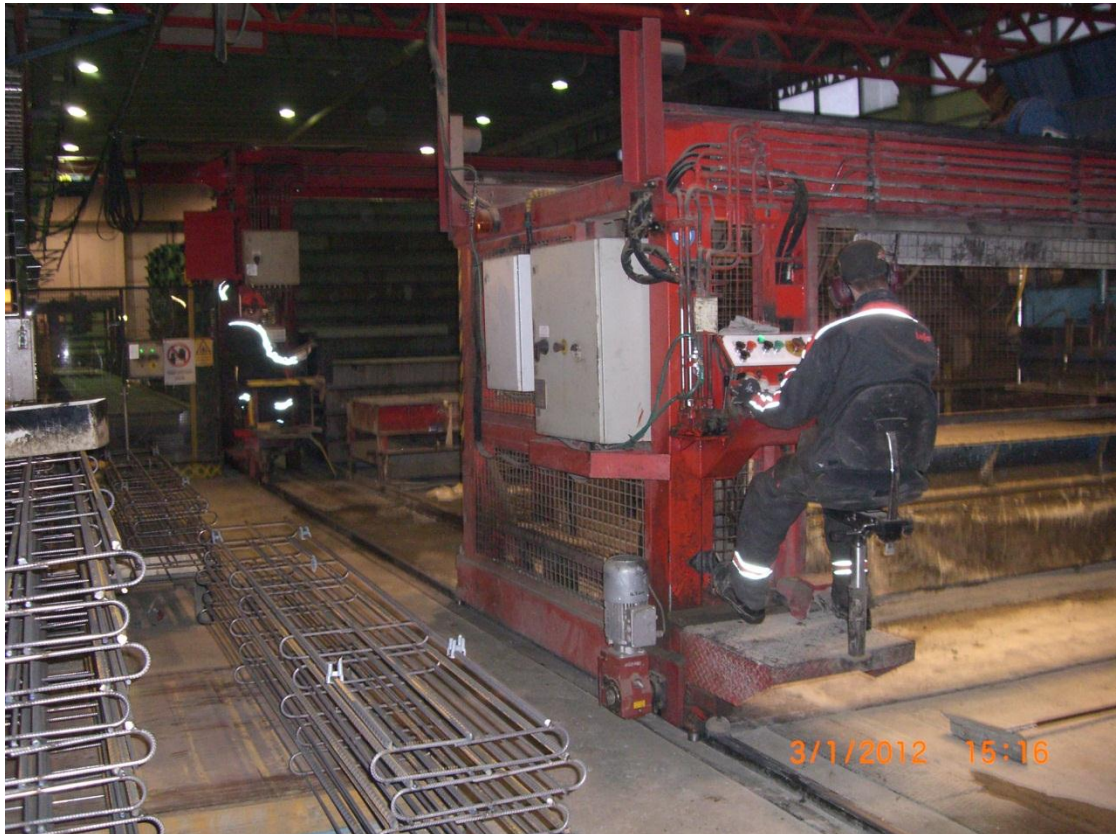
KUVA 9. Kasettiritiläpalkkien raudoitteita ja valukone (Pekka Kokkonen 2011)
