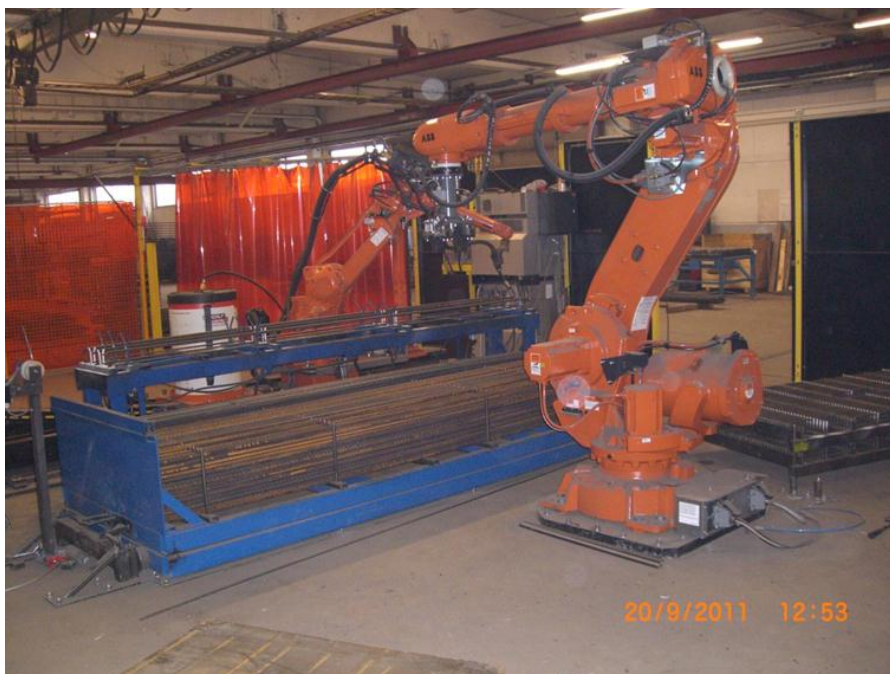
KUVA 7. Kappaleenkäsittelyrobotti IRB 6640–130/3,2 (Pekka Kokkonen 2011)
