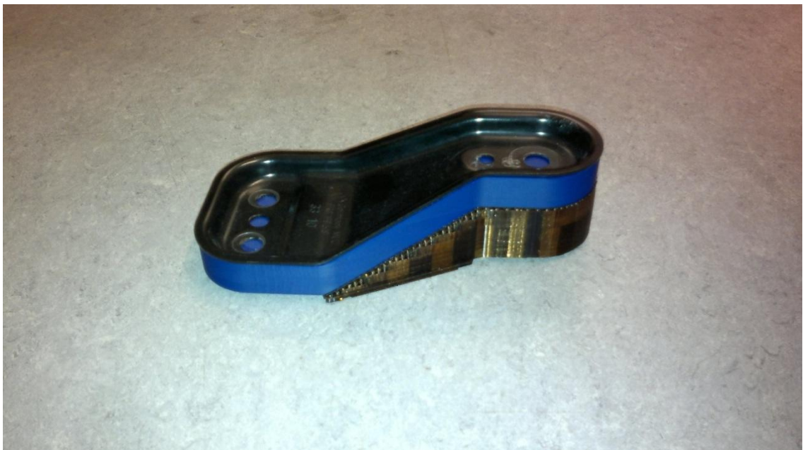
Kuva 7. Etuapurungon takakiinnikkeen mallinnuksen testaus 3D-tulosteen avulla.
