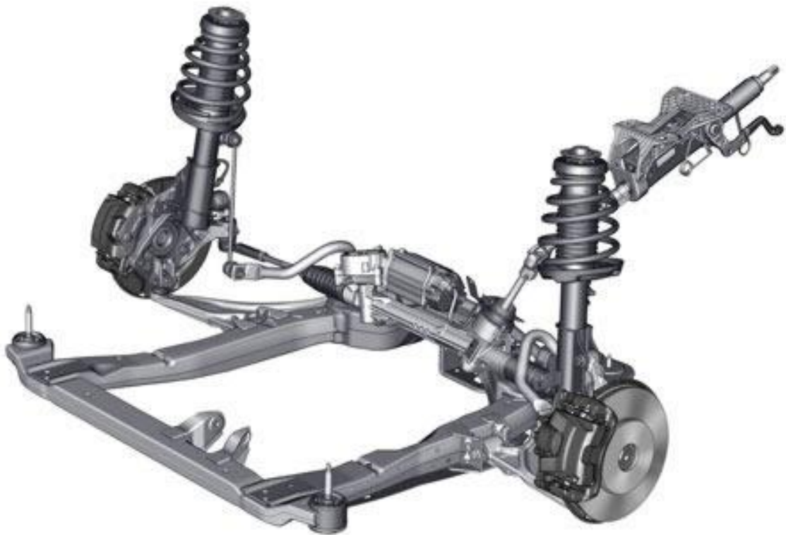
Kuva 3. Opel Astra J:n etuakselisto [2].
