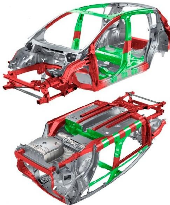
Kuva 2. Peugeot 3005:n korirakenne [1].
