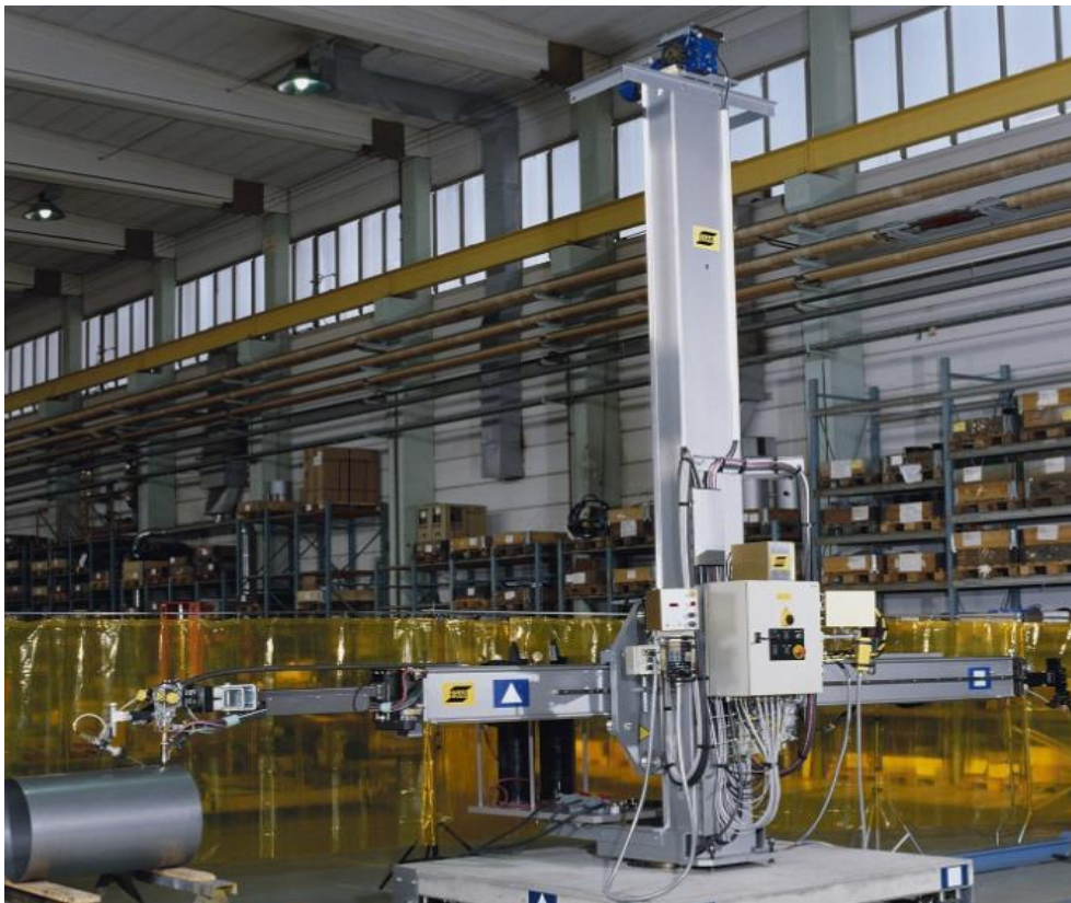
Kuva 7. Esabin hitsaustorni jauhekaarilaitteistolla
