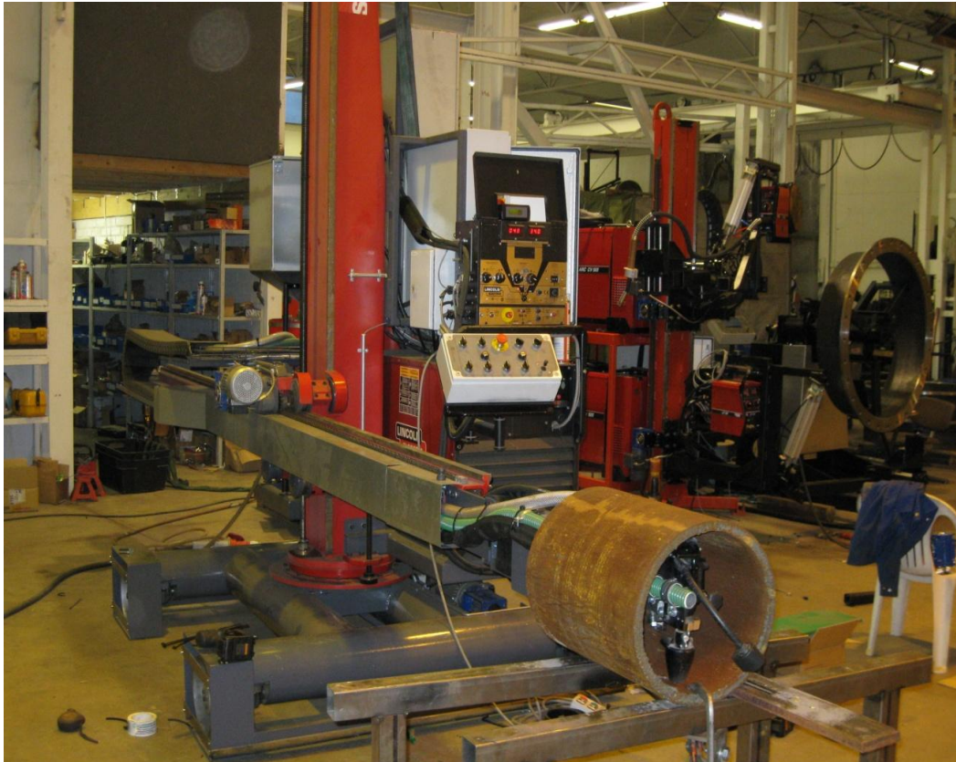
Kuva 5. Hitsaustorni varustettuna Lincoln jauhekaarihitsauslaitteistolla.
