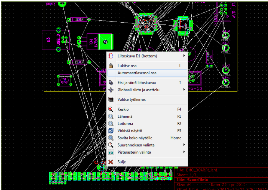
Kuvio 25. Komponenttien automaattiasemointi
