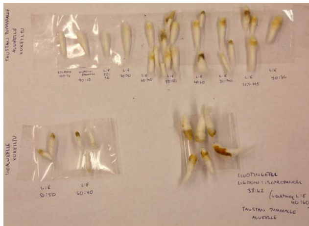
Kuva 38. Lakanpoistotesteissä käytettyjä pumpuleita. Yläreunassa ja vasemmassa reunassa näkyvät pumpulit ovat testeistä, joissa käytettiin nestemäisiä liuottimia. Oikean alakulman pumpulit ovat liuotingeelitesteistä.
