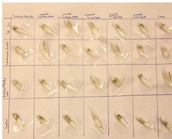
Kuva 35. Pintapuhdistustesteissä käytettyjä pumpuleita. Alimman vaakarivin pumpulit olivat sylkipuhdistustestissä.
