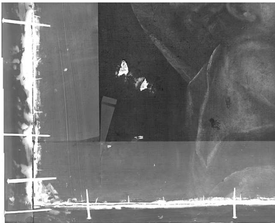
Kuva 33. Röntgenkuvassa näkyvät listojen kiinnittämiseen käytetyt erilaiset naulat. Pienimmät naulat ovat maalauksen pingotukseen käytettyjä nupinauloja.
