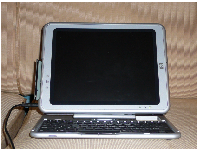
Kuva 5: HP Compaq TC1100 malli erikseen kiinnitettävällä näppäimistöllä julkaistiin jo 2003. Sen valmistus lopetettiin 2005, jonka jälkeen myös sen seuraajassa HP Compaq TC4200:ssa malli vaihtui perinteisempään, ilman erillistä näppäimistöä. (Wikipedia 2011b.)
