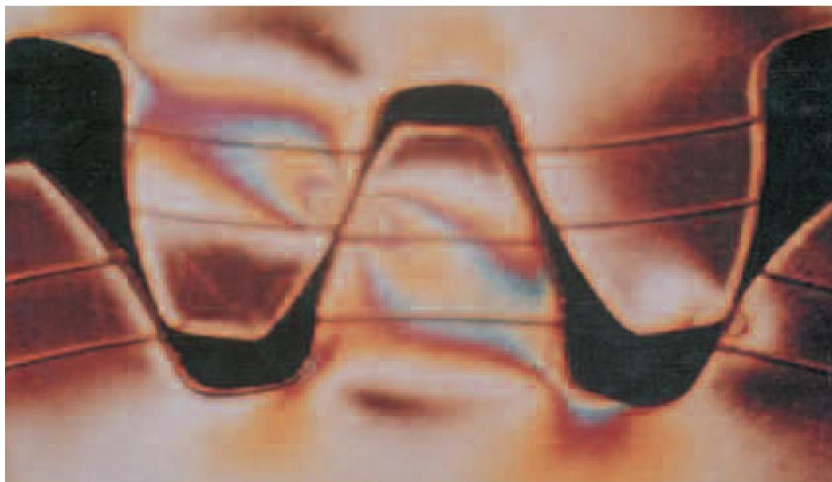
Kuvio 11. Polarisoitu näkymä hammaspyörän rasisuskohdista (Metal Improvement Company 2005, 19)
