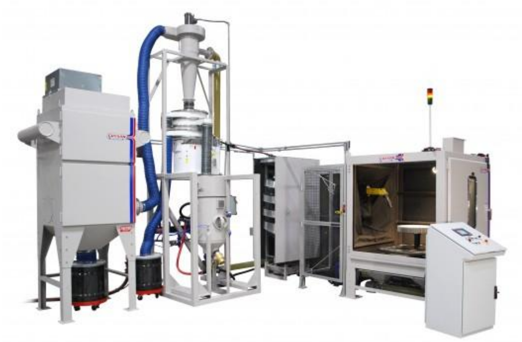
Kuvio 8. Guyson Corporationin RB-10 -kuulapuhallusrobottilaitteisto (Guyson Corporation 2009)
