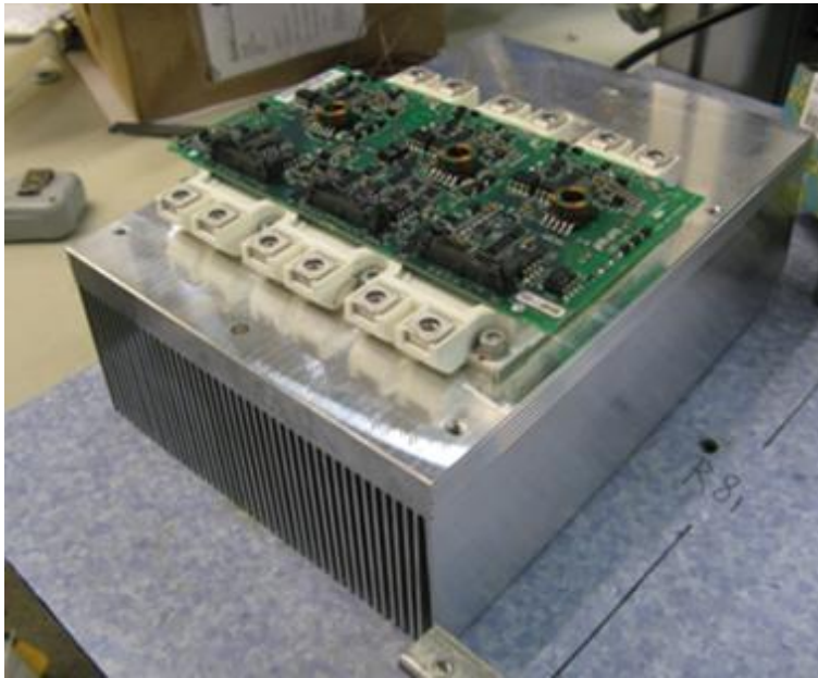
Kuvio 4. IGBT kiinnitettynä jäähdytuselementtiin.
