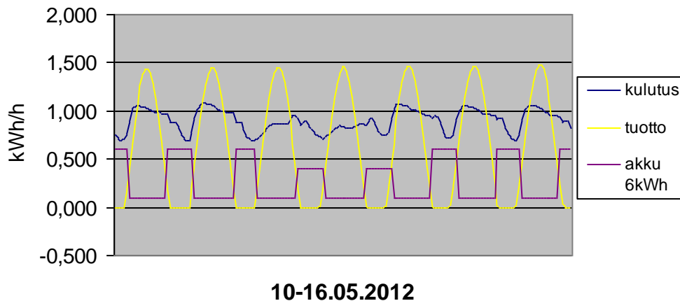
Kuva 21 Kohteen sähkönkulutus ja 2000W:n aurinkopaneelin laskennallinen tuotto 10-16.05, akku 6 kWh
