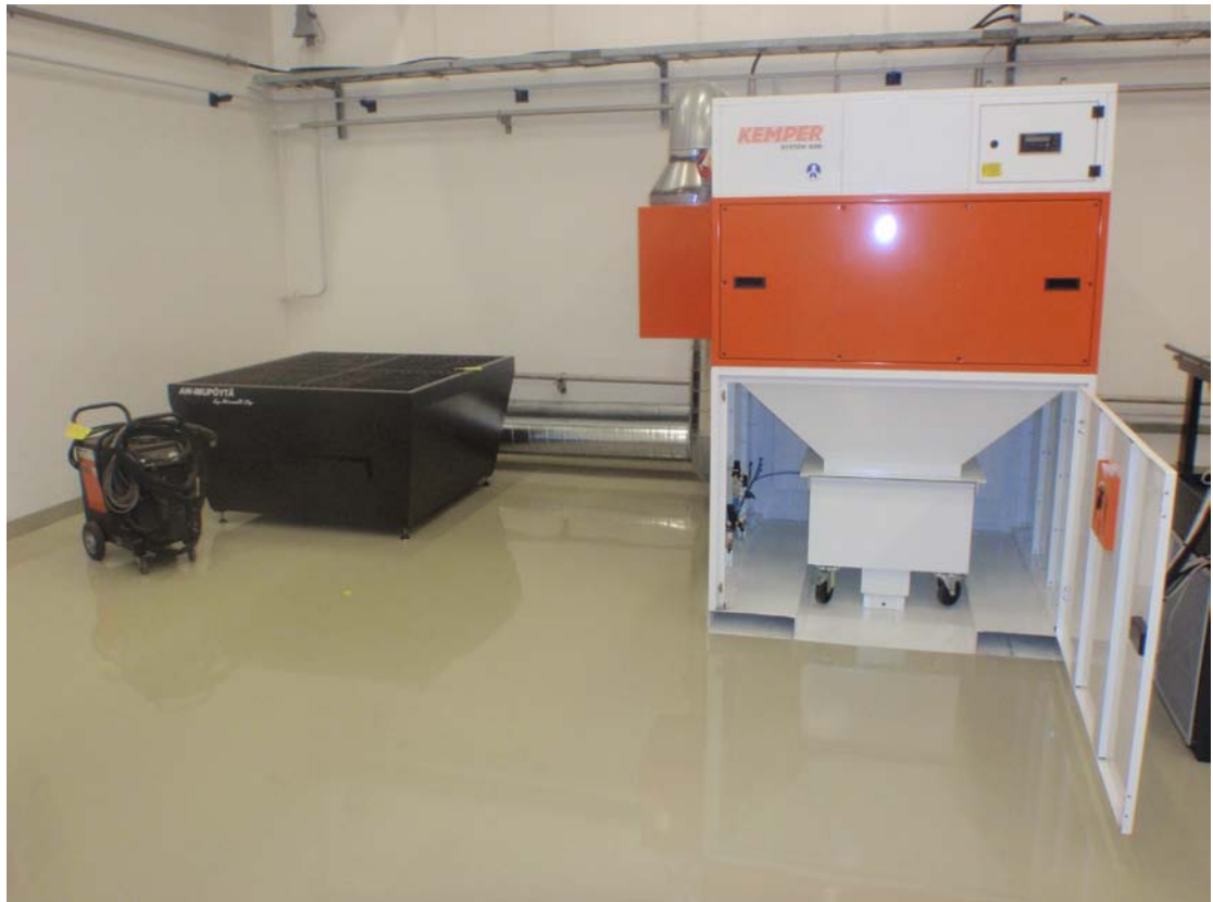
Kuva 5. Plasmaleikkuri, alaimupöytä ja suodatinyksikkö.
