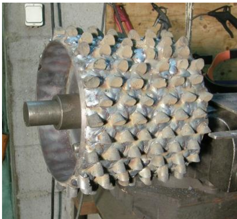
Kuva 39. Piikit hitsataan lopullisesti kiinni hitaasti rivi kerrallaan. (Kuva: Timo Ihalainen.)
