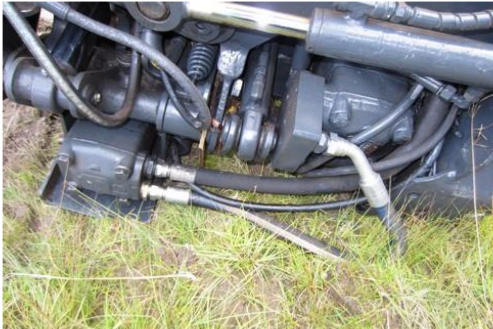
Kuva 40. Alasyöttörullan moottorin letkut ovat huonossa asennossa. (Kuva: Timo Ihalainen.)
