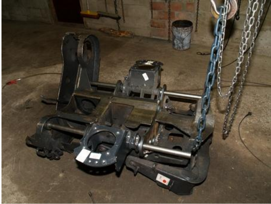
Kuva 21. Korvakelevyn reikien kohdistus syöttörullien runkoja ja akselia apuna käyttäen. (Kuva: Timo Ihalainen.)
