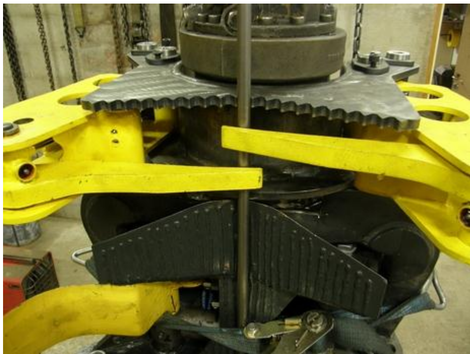
Kuva 51. Käpälät voivat tarttua nyt hyvinkin pieneen puuhun. (Kuva: Timo Ihalainen.)
