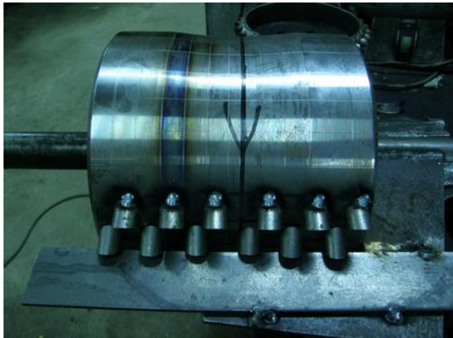
Kuva 38. Piikit eivät jätä tyhjää linjaa rullan pyöriessä. (Kuva: Timo Ihalainen.)
