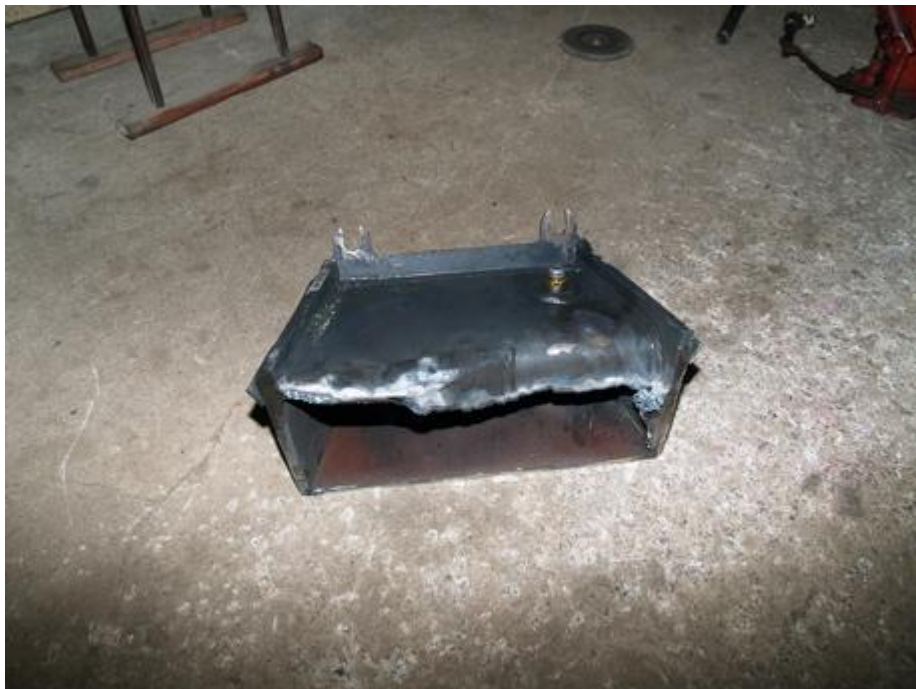
Kuva 28. Irti leikattu öljysäiliö. (Kuva: Timo Ihalainen.)
