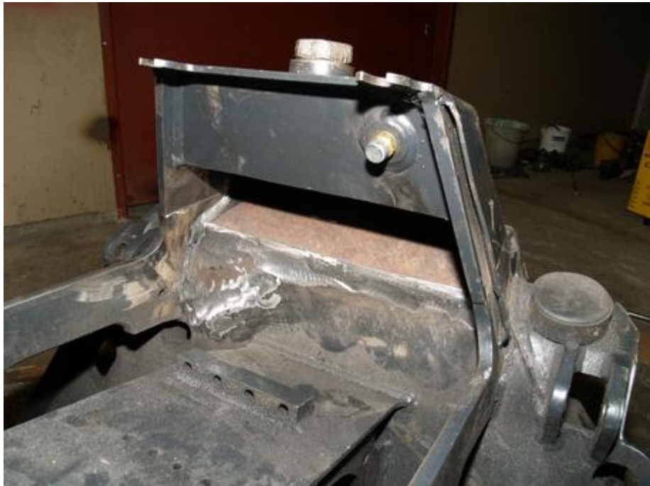
Kuva 30. Öljysäiliö tulevalla paikallaan. (Kuva: Timo Ihalainen.)
