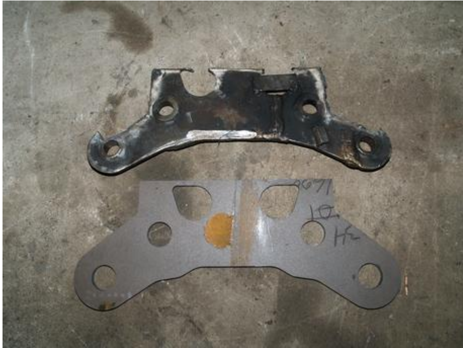
Kuva 20. Uuden ja vanhan korvakelevyn vertailu. (Kuva: Timo Ihalainen.)
