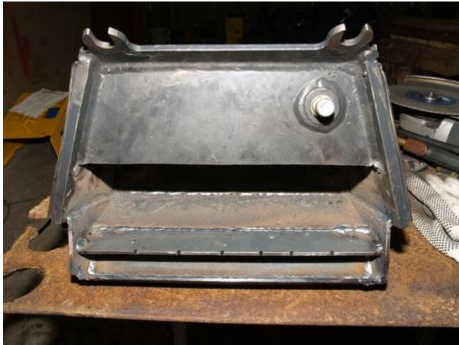
Kuva 32. Öljysäiliö valmiina. (Kuva: Timo Ihalainen.)
