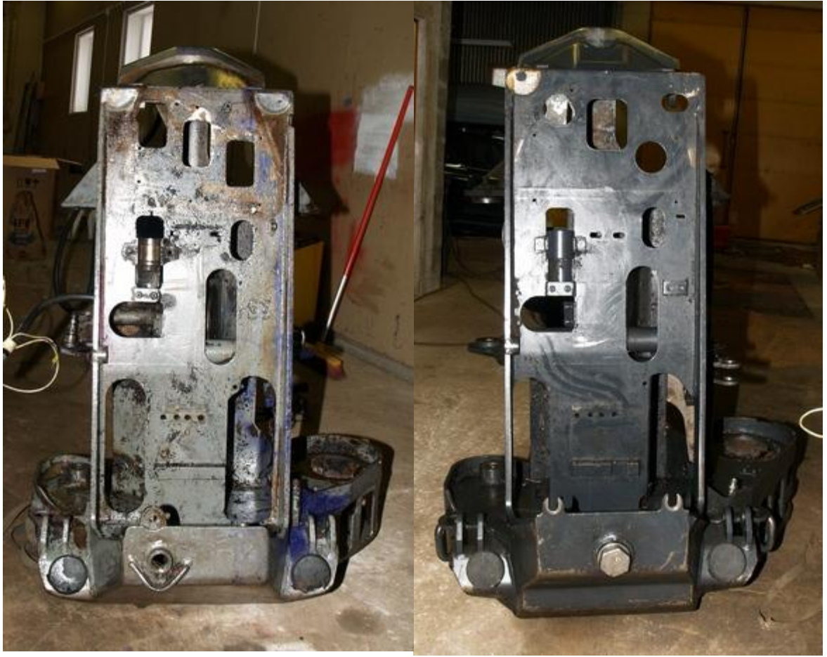
Kuva 15. Vasemmalla vanha H53- ja oikealla uusi H53e-runko takaa kuvattuna. (Kuva: Timo Ihalainen.)
