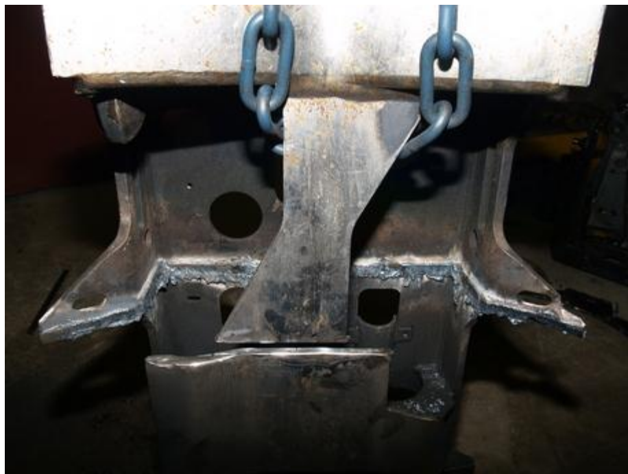
Kuva 17. Runko korvakelevyn irrotuksen jälkeen. (Kuva: Timo Ihalainen.)
