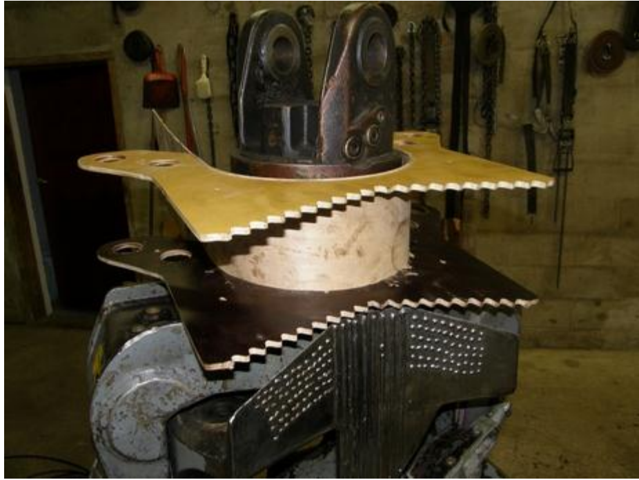
Kuva 47. Vanerimalli EH25-kouran runkolevystä. (Kuva: Timo Ihalainen.)
