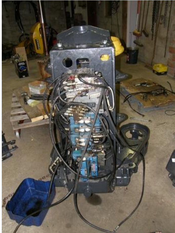
Kuva 36. Venttiilipöytä paikoillaan. (Kuva: Timo Ihalainen.)
