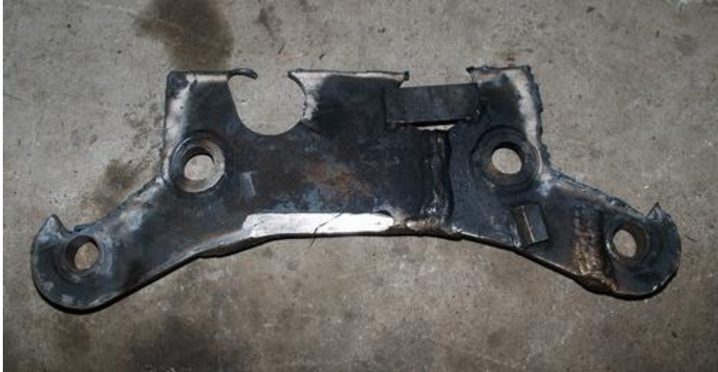
Kuva 18. Irti leikattu korvakelevy jonka perusteella mitoitettiin uusi. (Kuva: Timo Ihalainen.)
