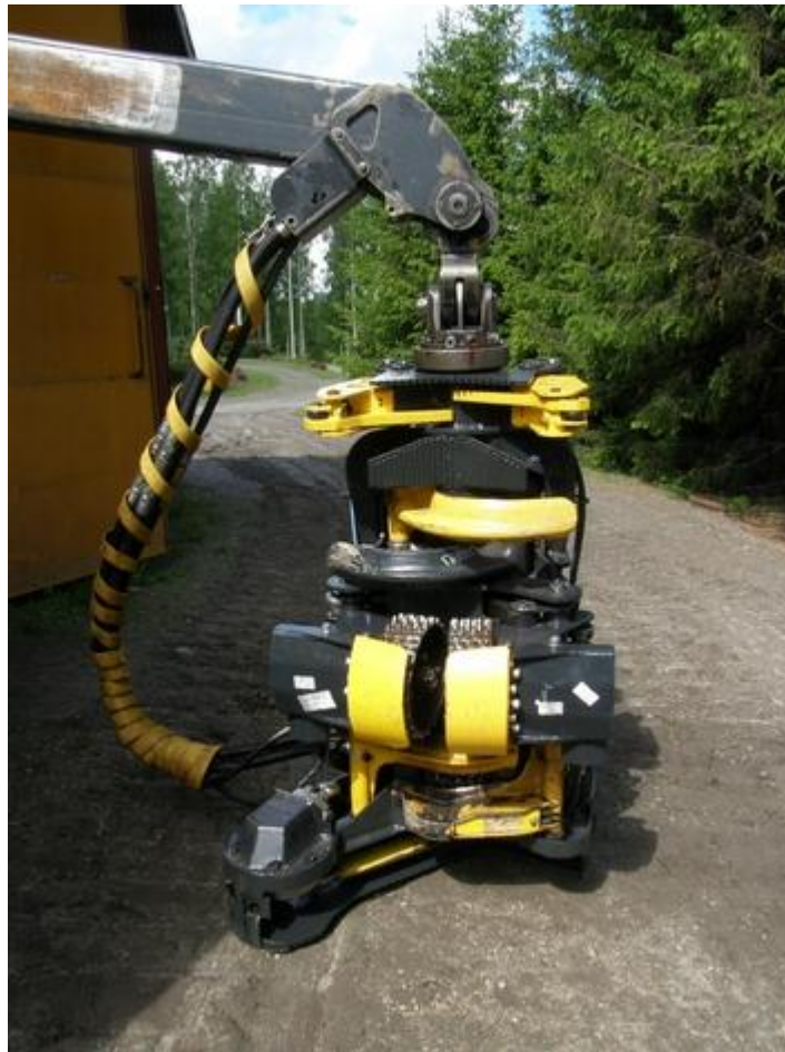
Kuva 50. Uudistettu joukkokäsittelykoura, jossa ylimääräiset letkut ovat piilossa kouran takapuolella, suojakopan alla. (Kuva: Timo Ihalainen.)
