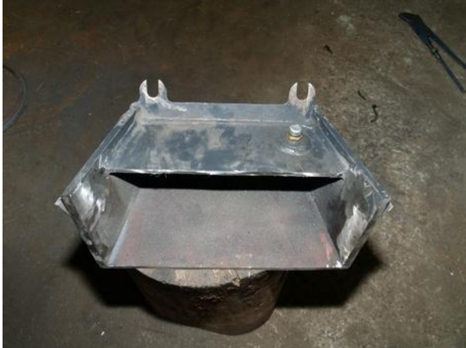
Kuva 29. Öljysäiliö hiottuna ja siistittynä. (Kuva: Timo Ihalainen.)
