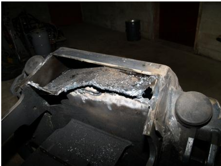
Kuva 25. Öljysäiliön pohja. (Kuva: Timo Ihalainen.)
