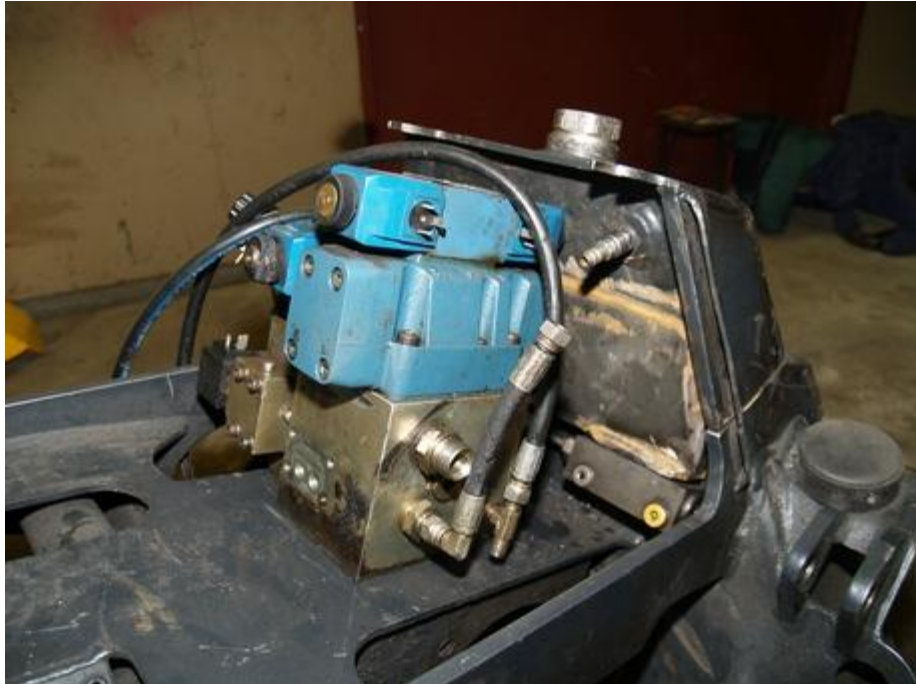
Kuva 33. Öljysäiliö paikoillaan. (Kuva: Timo Ihalainen.)
