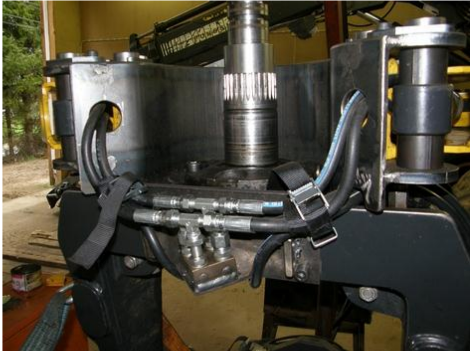
Kuva 51. Letkut jakautuvat kannen alla molemmille puolille. Kansi ei ole kuvassa. (Kuva: Timo Ihalainen.)
