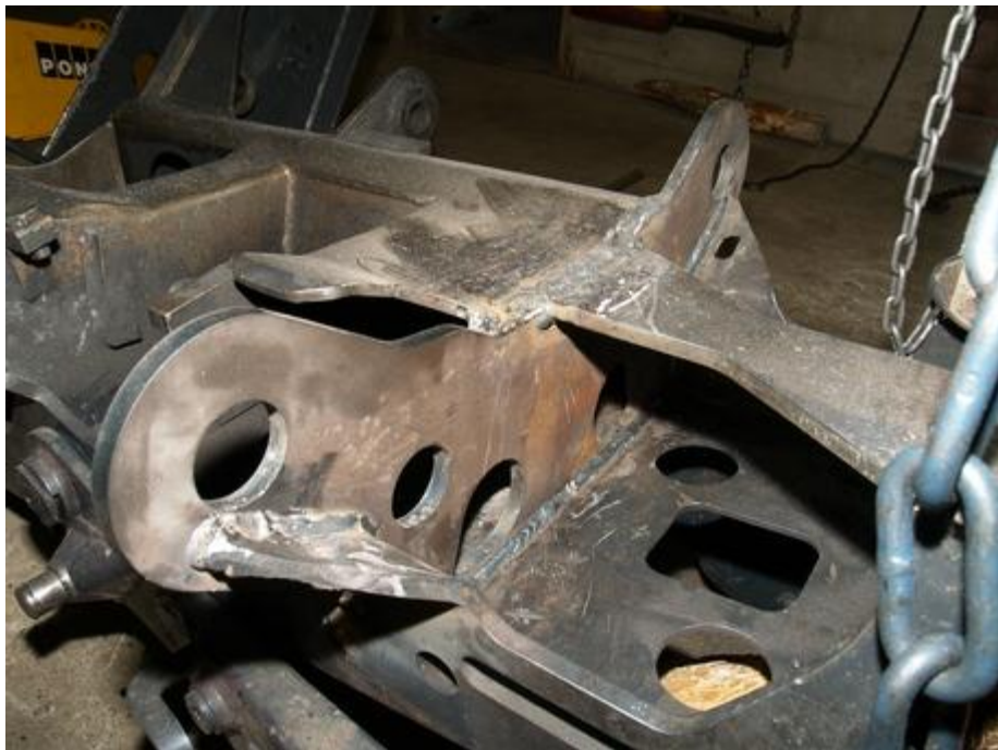
Kuva 22. Korvakelevy kiinni hitsattuna. (Kuva: Timo Ihalainen.)
