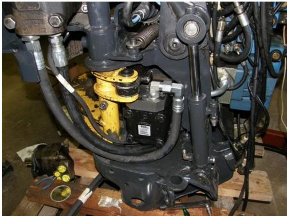
Kuva 42. Paineletku kulkee nyt lähempänä kouran runkoa ollen paremmin suojassa. Tankkilinjan letku on suojassa runkopalkin takana. (Kuva: Timo Ihalainen.)
