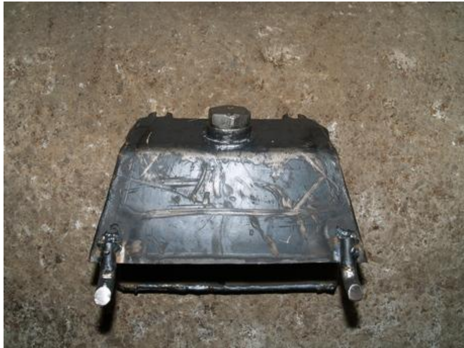
Kuva 31. Kiinnitys toteutettiin koukuilla. (Kuva: Timo Ihalainen.)
