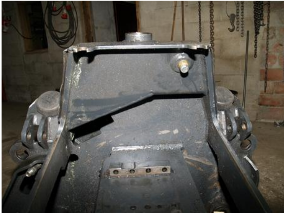
Kuva 24. Säiliön pohjaa ei pysty leikkaamaan kulmahiomakoneella. (Kuva: Timo Ihalainen.)
