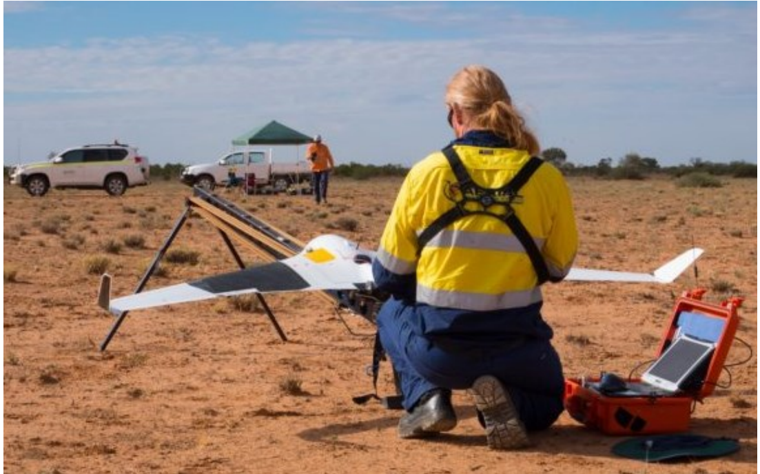
Kuva 5. Kiinteäsiipinen drone laukaistualustalla (Chapman 2016.)
