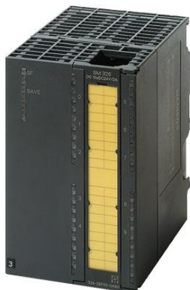
Kuva 22 Digitaalinen turvamallin sisääntulokortti 6ES7326-1BK02-0AB0 (Siemens Osakeyhtiö www-sivut 2012)
