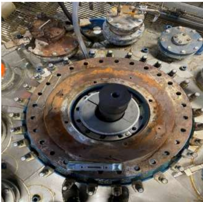
Kuva 14. Kannen suoraan asennus kolmella mittauspisteellä.
