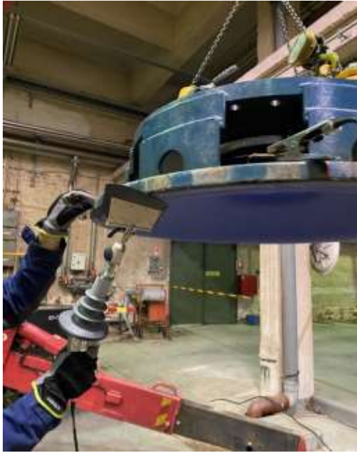
Kuva 3. Reaktorin kannen kipinätarkastus.
