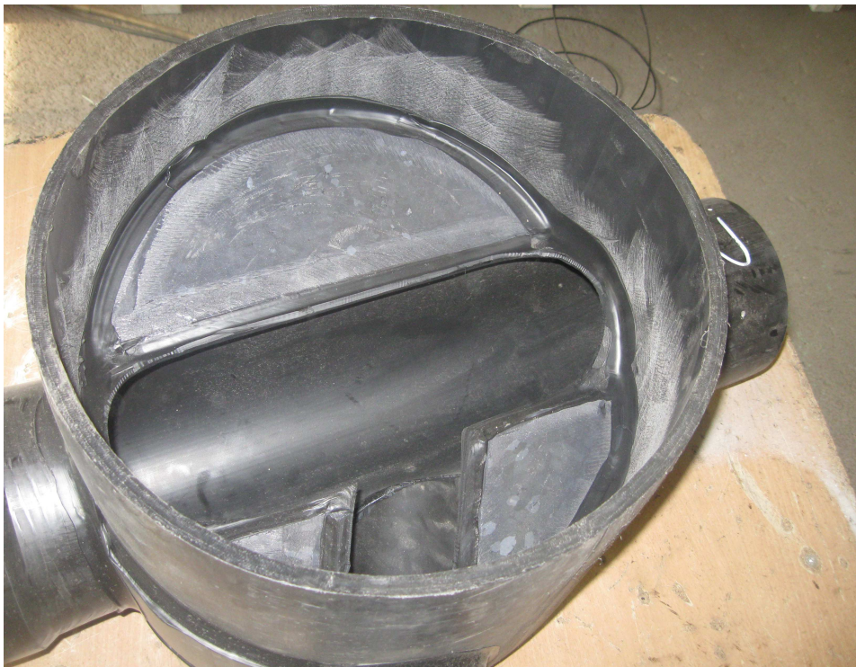
Kuva 3. JVTK:n rungon y-haarainen pohja. (Kuva: Mika Rahunen)
