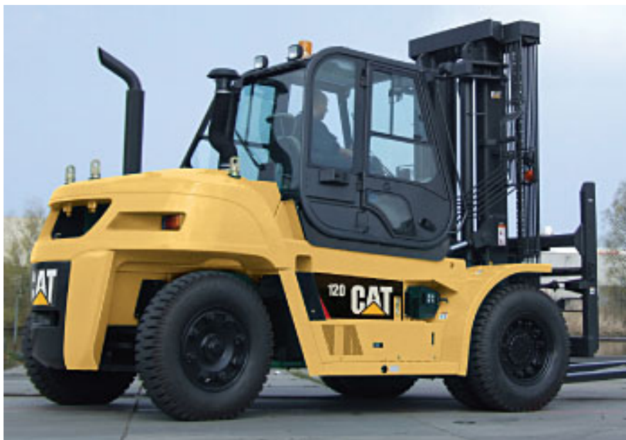
Kuva 4 Vastapainotrukki on yleisin trukkityyppi (www.thttkauppa.fi)
