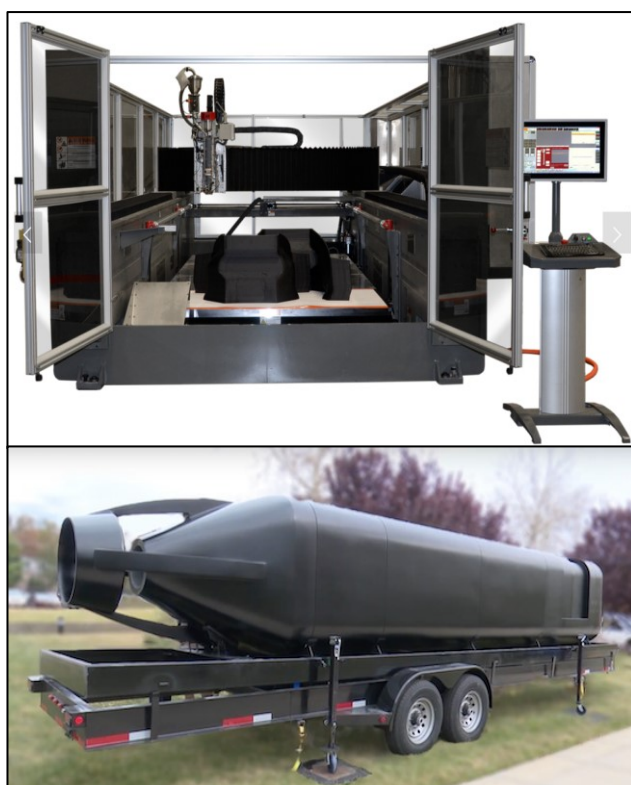
Kuva 5. Ylhäällä BAAM laite (Cincinnati Inc.) ja alhaalla hiilikuitukomposiittista BAAM laitetta käyttäen valmistettu sukellusveneen runko (Jackson 2017).
