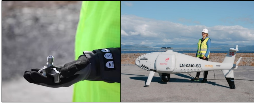
Kuva 30. 3D-tulostetun pelastusveneen moottorin polttoainesuutin ja sen kuljetukseen käytetty drone (Equinor 2020).
