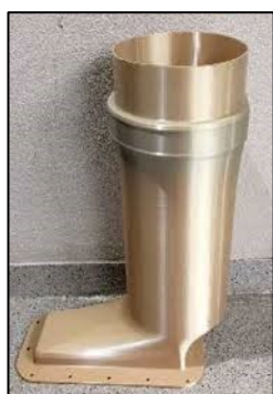
Kuva 43. C-17 Globemaster III sotilaskuljetuskoneen 3D-tulostettu jäähdytyskanava (Report No. DODIG-2020-003 2019).
