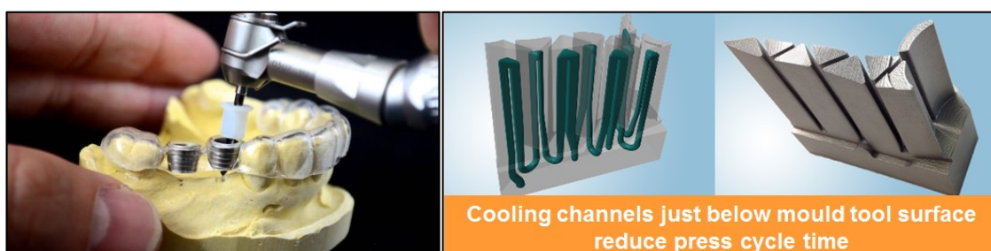
Kuva 11. Hammasimplantin porausohjain vasemmalla ja muottityökalu sisäisillä jäähdytyskanavilla oikealla (Valluri 2019; Renishaw plc.).
