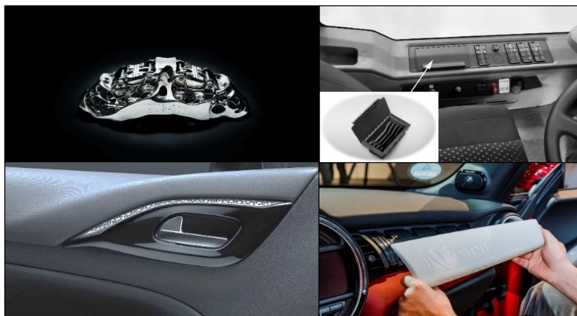
Kuva 21. 3D-tulostamalla valmistettuja ajoneuvon osia; jarrusatula, luottokorttikotelo, koristelista autonovessa ja räätälöity kojelautapaneeli (Sher 2020a).
