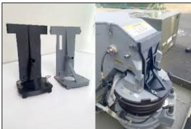
Kuva 42. Perinteisesti valmistettu ja 3D-tulostamalla valmistettu MH-60R helikopterin sonar-järjestelmän kansi (Report No. DODIG-2020-003 2019).
