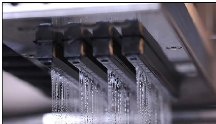
Kuva 1. Sideaineen syöttö InkJet tulostinpäistä (ExOne).
