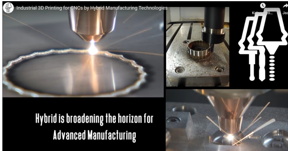
Kuva 4. Hybridilaitte, jossa on yhdistettynä suorakerrostus ja CNC-koneistuskeskus (Hybrid Manufacturing Technologies).
