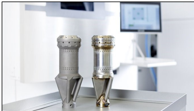
Kuva 27. 3D-tulostettuja kaasuturbiinin polttimia, vasemmalla käyttämätön ja oikealla vuoden käytössä ollut poltin (Siemens Energy 2018).
