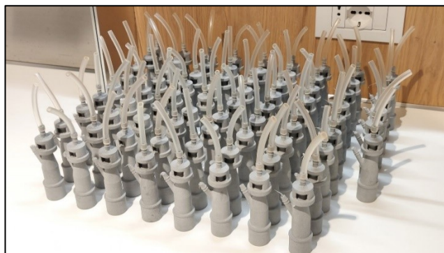
Kuva 17. Tarvittaessa 3D-tulostettuja hengityslaitteen venttiilejä (Hahn 2020).
