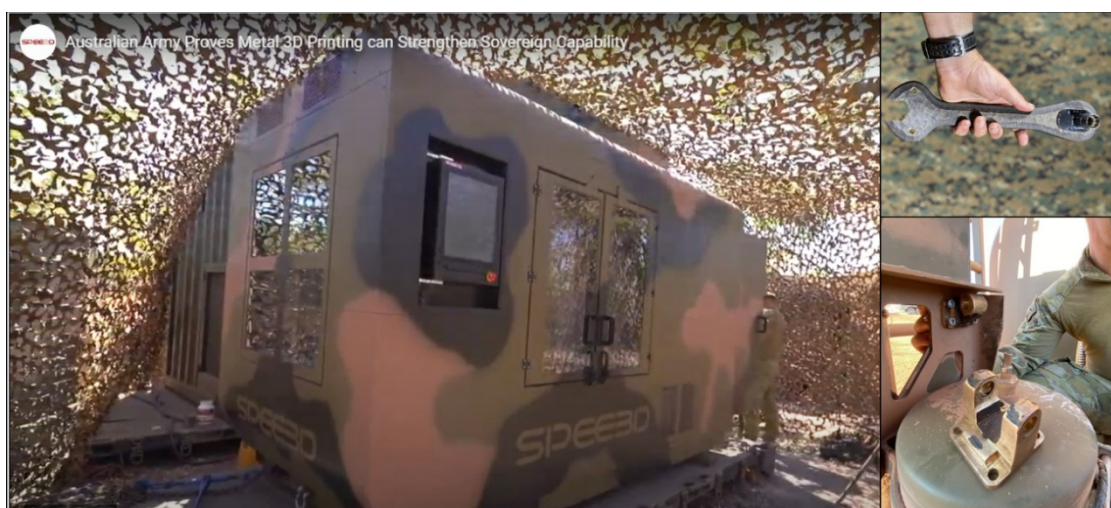
Kuva 47. Australian maavoimien WarpSPEE3D-tulostin sekä 3D-tulostetut ja koneistamalla viimeistellyt räikkä ja kannake (SPEE3D 2020).
