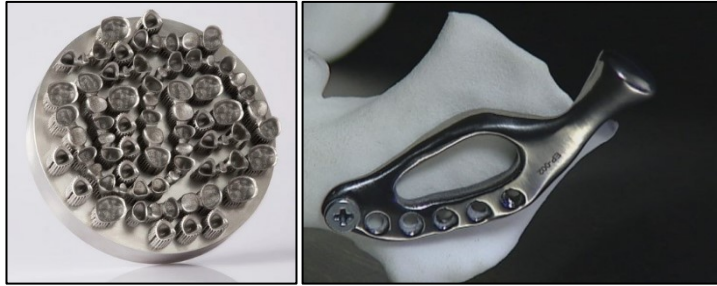
Kuva 18. 3D-tulostettuja hammaskruunuja ja -siltoja tulostusalustalla vasemmallä ja titaaninen leukaluun osa oikealla (EOS; Ferrier 2015).
