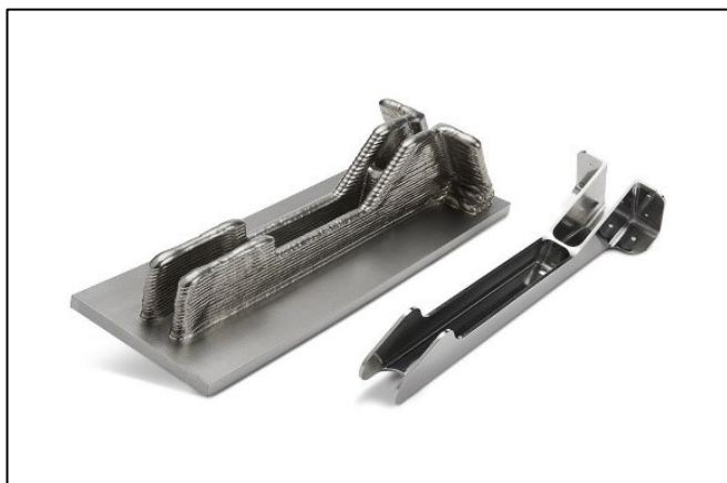
Kuva 3. Vasemmalla Norsk Titaniumin RPD-tekniikalla valmistama kappale tulostuksen jälkeen ja oikealla siitä koneistamalla viimeistelty kappale (The Additive Report 2018).
