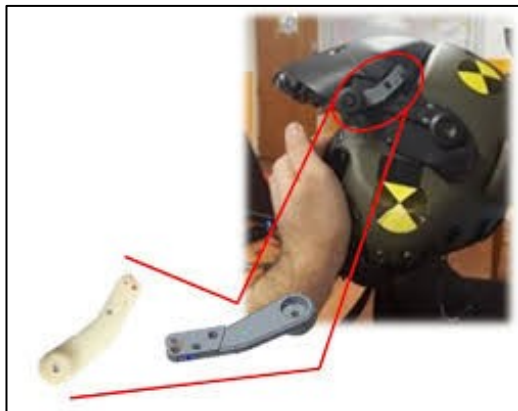
Kuva 44. Helikopterikypärän visiirin 3D-tulostettu kiinnike (Report No. DODIG-2020-003 2019).
