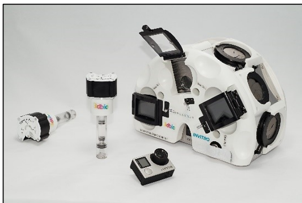
Kuva 32. Organ.Aut biotulostin, joka on suunniteltu biologisen materiaalin tulostamiseen painottomissa olosuhteissa (3D Bioprinting Solutions 2018).
