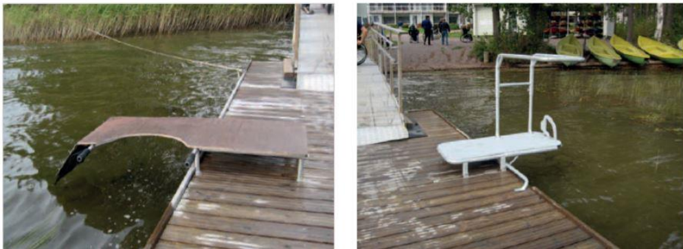
KUVA 31. Esimerkkejä Pajulahden liikuntakeskuksesta apuvälineistä, joiden avulla liikuntaesteinen pääsee siirtymään kajakkiinsa (31, s. 3)
