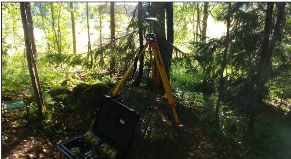
Kuva 8. Kesällä Geotrimin testipisteradalla suoritettu testimittaus Topcon Hiper HR VR -vastaanotin. ja NovAtel VEXXIS GNSS-850 -antennilla.
