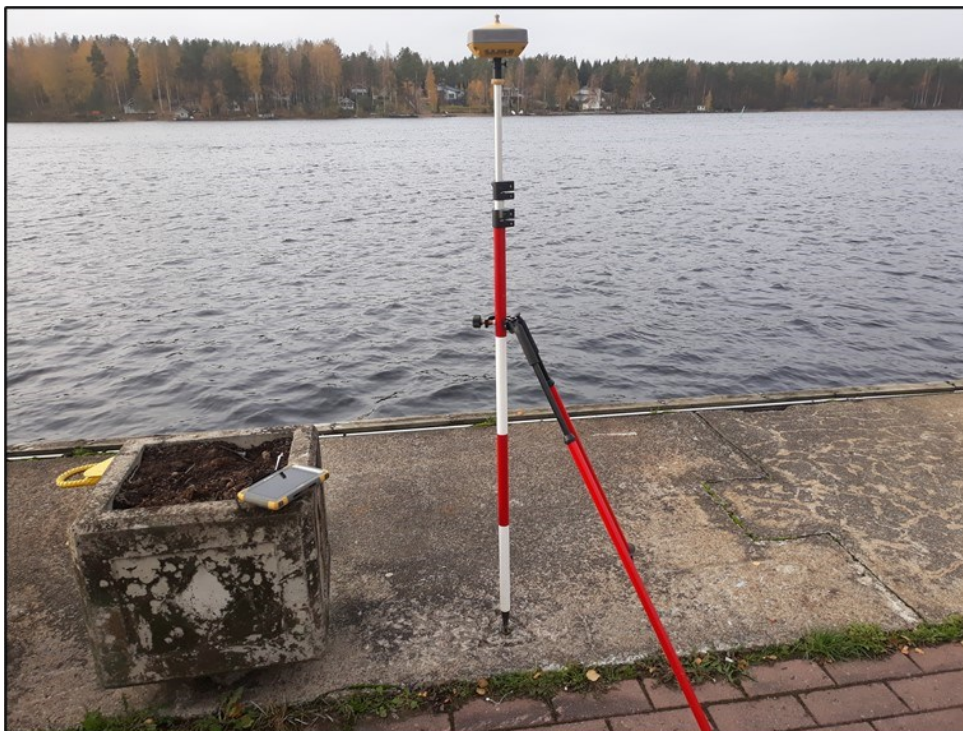
Kuva 10. Aukealla kiintopisteellä 88M8816B suoritettu testimittaus. Kuvassa Topcon Hiper VR -vastaanotin.
