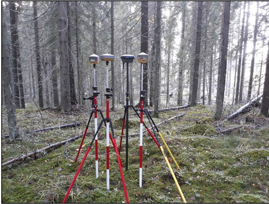
Kuva 9. Juvan alueella suoritettu testimittaus peitteisessä maastossa. Vastaanottimet vasemmalta oikealle: Topcon Hiper HR, Topcon Hiper VR, Leica GS18 I GNSS RTK ja Topcon Hiper HR.
