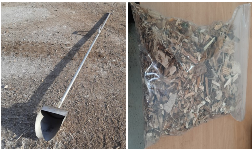
Kuva 10. ja 11. Näytteenottokauha ja näytepussi (kuvannut Ari Niemi).
