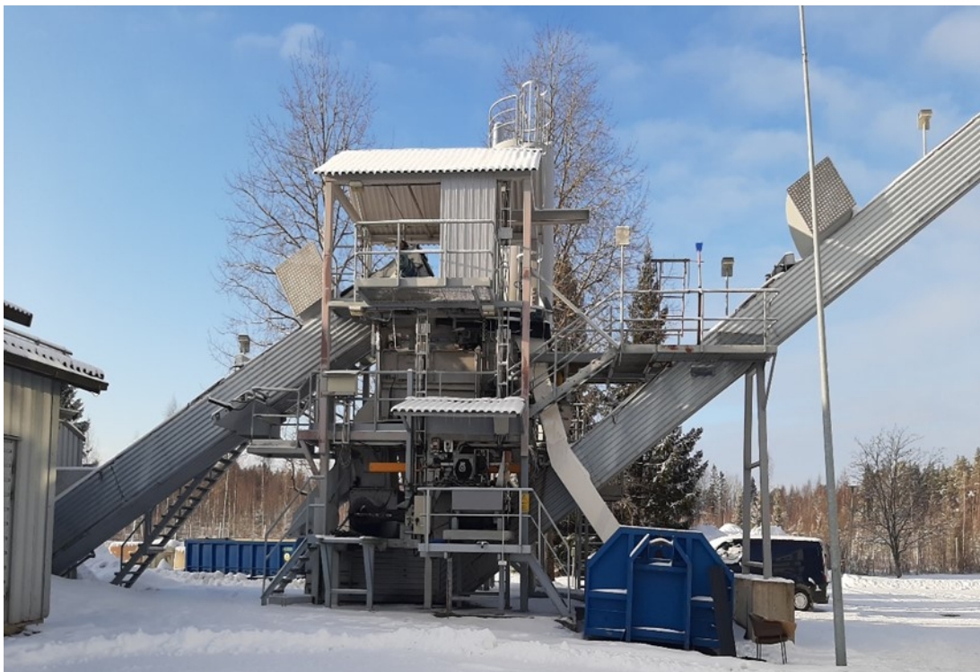
Kuva 3. Seulomo, jonka oikealla puolella on yläkuljetin ja vasemmalla puolella alakuljetin (kuvannut Ari Niemi).
