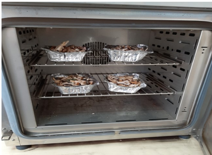
Kuva 12. Näyteuuni (kuvannut Ari Niemi).
