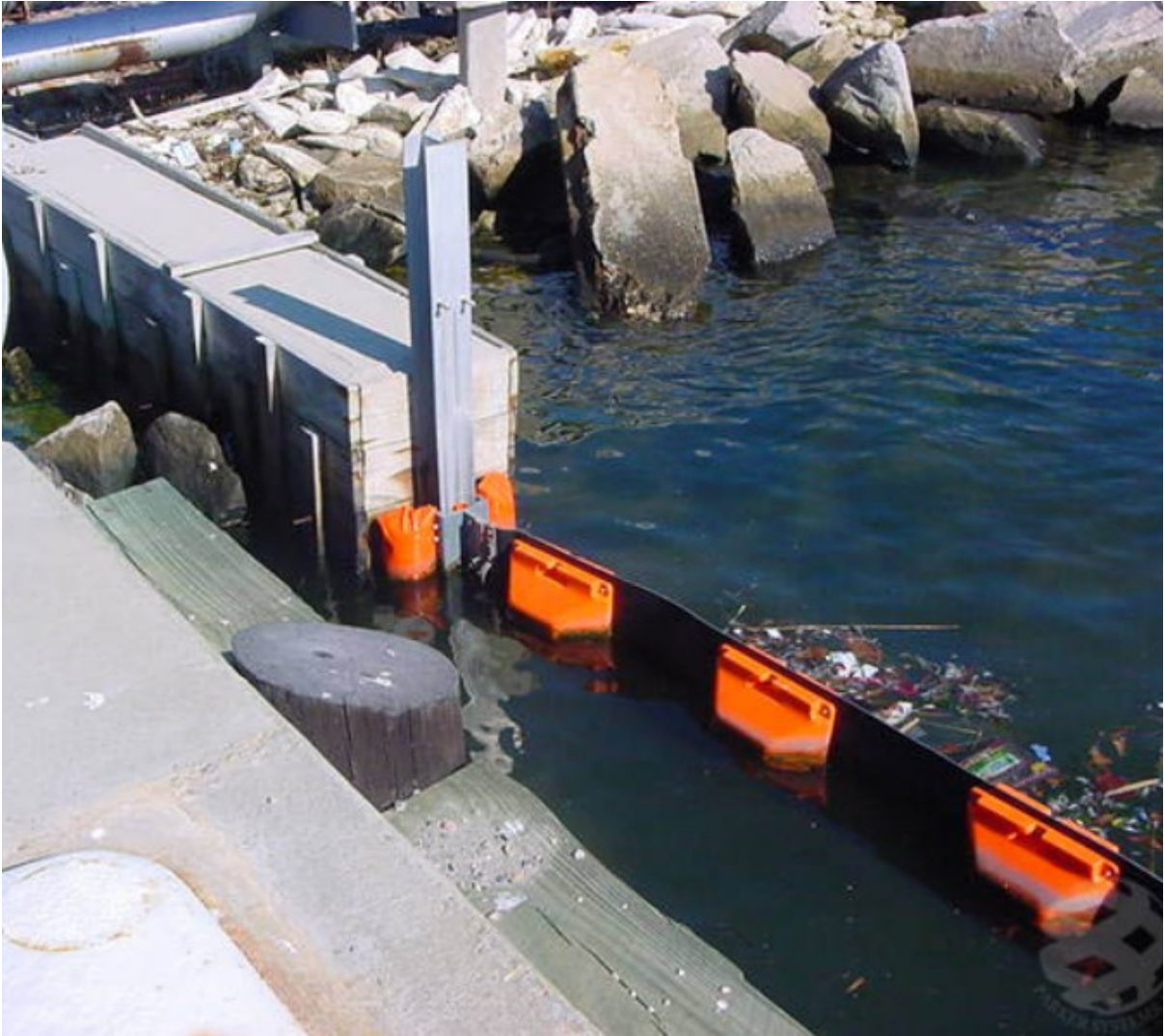
KUVA 10. Havainnollistava kuva veden pinnan kompensattorista (20)
