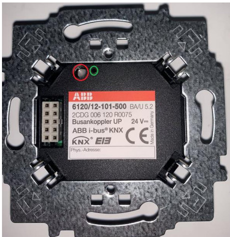
Kuva 27. Väyläliitinyksikön ohjelmointiled ja painike.
