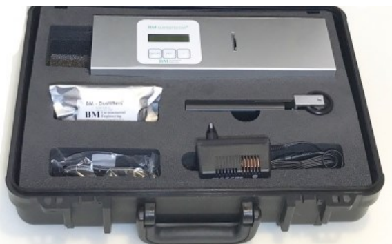
KUVA 14. BM dustdetector. (Astq 2021)
