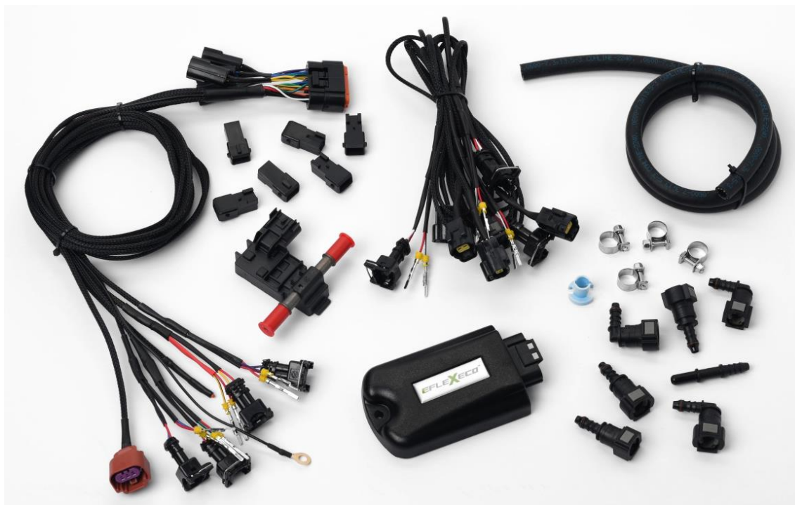
KUVA 4. eFlexFuel muutossarjan sisältö (eFlexFuel 2020)
